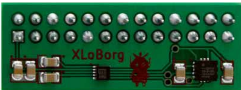
Unten Die Platine besitzt einen Beschleunigungsmesser und ein Magnetometer mit drei Achsen, kann also Neigung und Richtung messen.
