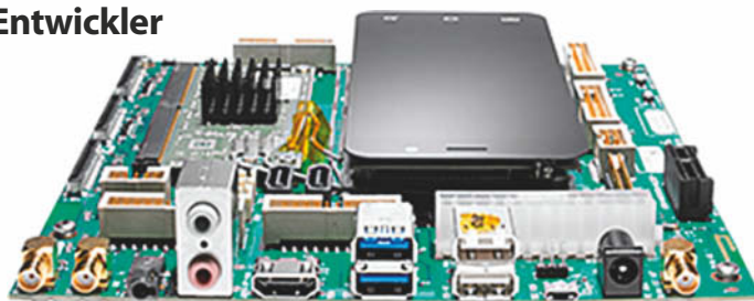
Das DragonBoard 810 bietet vollen Zugriff auf die Technik eines High-End-Smartphones. Was wie ein solches aussieht, ist das aufgesteckte, optionale Display-Modul.
