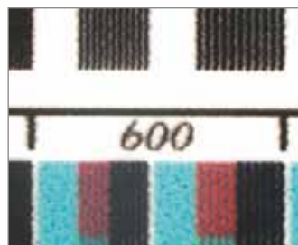
Canons Pixma-Pro-Drucker (links Pro-10S, Mitte Pro-100S) lösen 600 Punkte pro Zoll deutlich sauberer auf als billigere Pixmas (rechts iP2700 als Beispiel).
