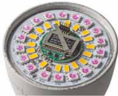
In der Seed Bulb stecken zwei LED-Kränze (warmweiß und RGB-Effekt), die Antenne ist nach oben abgesetzt.
