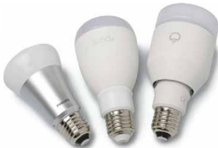
Die Bluetooth-Smart-Lampe von Seed (Mitte) ist größer als Philips' ZigBee-Modell Hue (links), aber immer noch kleiner als die WLAN-Lampe von Lifx.
