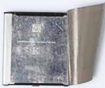
Der Fake-Akku hat dieselbe Modellnummer, aber eine andere Zelle.
