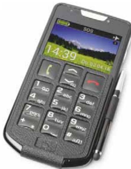
Mit vorgeklappter Tastatur verhält sich das Emporia Smart wie ein einfaches Handy.
