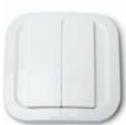
Der Switch S4 versendet Befehle über zwei Kanäle. Als Gegenstellen kommen aktuell die Proxi-Geräte und die Seed Bulb in Betracht.
