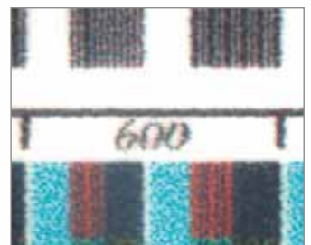
Canons Pixma-Pro-Drucker (links Pro-10S, Mitte Pro-100S) lösen 600 Punkte pro Zoll deutlich sauberer auf als billigere Pixmas (rechts iP2700 als Beispiel).
