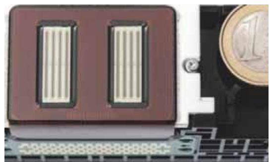
Der Druckkopf des Canon Pixma Pro-100S besteht aus 6144 Einzeldüsen, 768 für jede Farbe.
