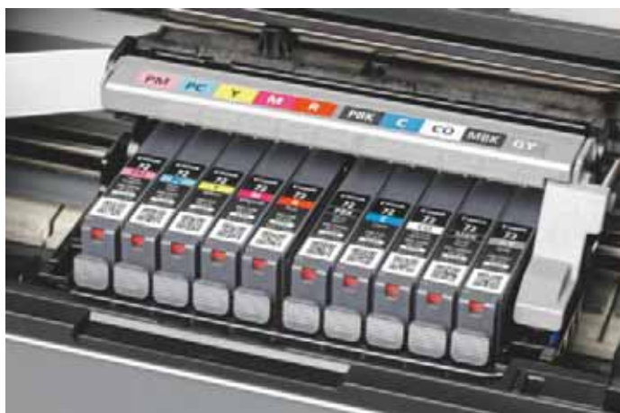
Der Kopfschlitten des Pixma Pro-10S enthält zehn Patronen, von denen neun Farben enthalten und die zehnte den Klarlack „Chroma Optimizer“.
