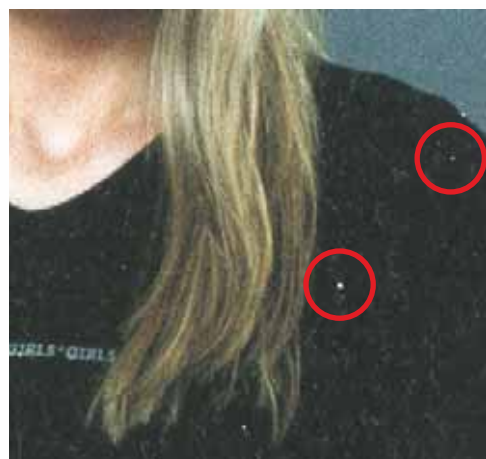
Auf texturiertem Papier sollte man nicht in der höchsten Auflösung (Fein) drucken, da die feinen Tintentröpfchen sonst manche Vertiefungen nicht erreichen und auf dem Foto unschöne, nadelstichartige Punkte hinterlassen.
