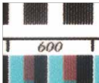
Canons Pixma-Pro-Drucker (links Pro-10S, Mitte Pro-100S) lösen 600 Punkte pro Zoll deutlich sauberer auf als billigere Pixmas (rechts iP2700 als Beispiel).
