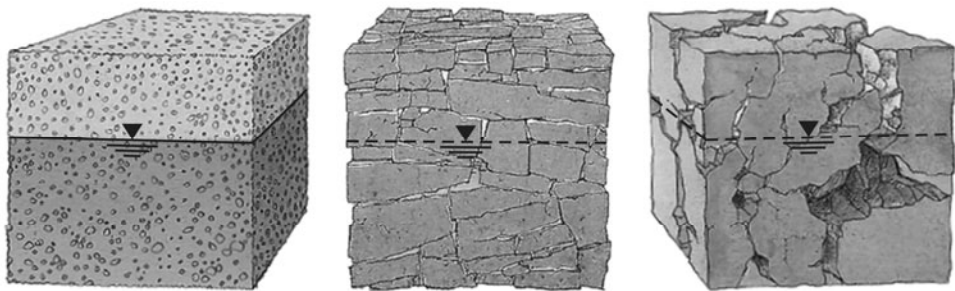
Abb. 3-11: Porengrundwasserleiter (links) – Kluftgrundwasserleiter (mitte) – Karstgrundwasserleiter (rechts)
