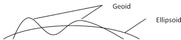
Abb. 1.19 Abweichung des Geoid vom Ellipsoid, Quelle: Autor
