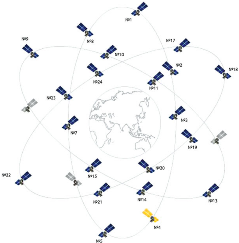
Abb. 4.2 Konstellation der GLONASS-Satelliten, Quelle: ESA
