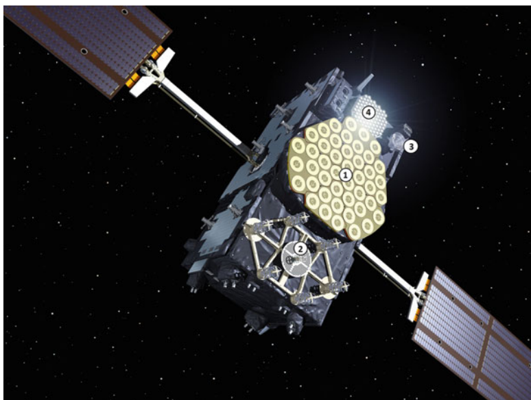
Abb. 5.5 Galileo IOV Satellit, 1 L-Band Antenne, 2 SAR-Antenne, 3 C-Band Antenne, 4 Laserreflektor, Quelle: ESA
