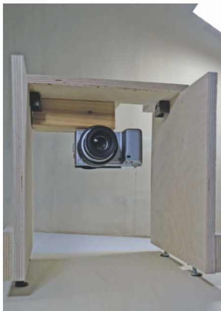
Ein Holzstativ bringt die Kamera vor dem Projektor in Position. Einschlaggewinde machen es höhenverstellbar.
