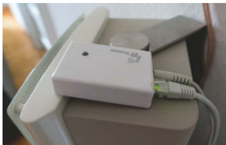
Ersetzt die originale Infrarot-Fernbedienung: Das IRTrans-Modul der gleichnamigen deutschen Firma.
