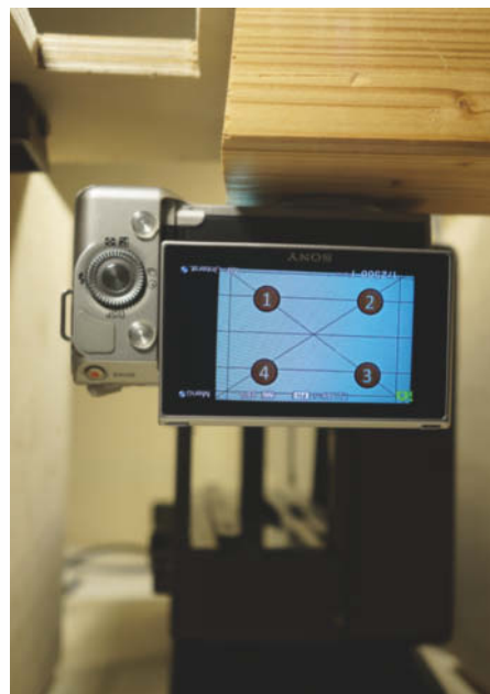
Zum Scharfstellen auf die Bildebene dient ein Kalibrier-Dia oder ein sehr detailreiches Motiv.
