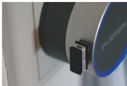
Der USB-Beacon ist der kleine Stick an der Seite. Das große runde Teil ist nur das USB-Netzteil (mit zwei Anschlüssen).
