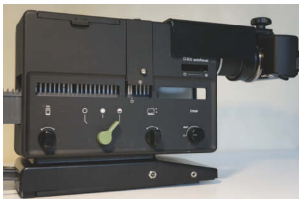
Der Diaprojektor Braun D300 als Repro-Station: Das Objektiv der Kamera (oben rechts) liegt im Projektor. So stört kein Umgebungslicht die Belichtung.
