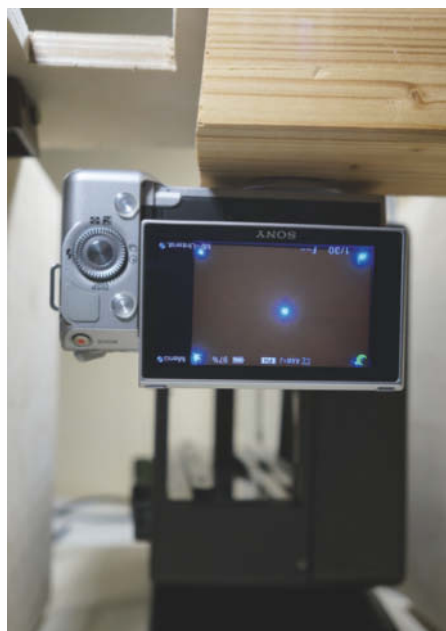
Ein lichtdichtes Dia mit vier Löchern an den Ecken hilft beim Ausrichten der Kamera vor dem Projektor.
