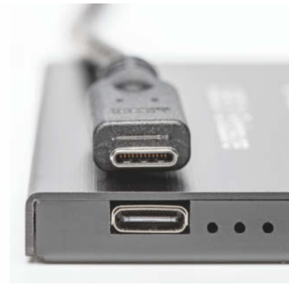
Die neuen Typ-C-Stecker haben kein oben und kein unten mehr und können mehr als nur USB übertragen.
