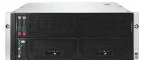
Mit dem HP Apollo 4510 lassen sich 5,4 Petabyte in einem Rack speichern.
