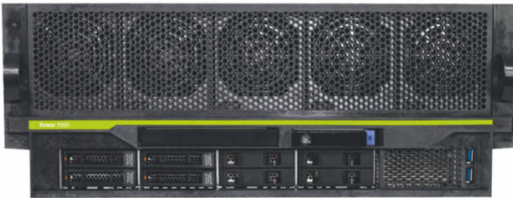
IBM Power System E850 mit vier Power8 und bis zu 4 TByte RAM
