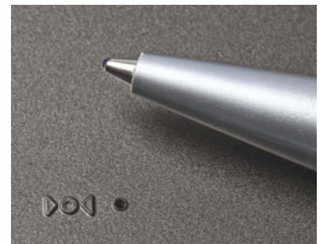
Gut versteckt: Mit Hilfe einer Büroklammer kann durch ein kleines Loch an der Rückseite der Erweiterungseinheit ein Resetknopf betätigt werden. Das ermöglicht zumindest temporär eine Nutzung im Bluetooth-Modus.
