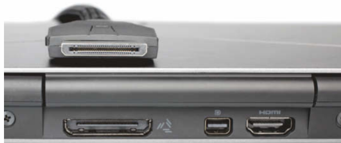
Über eine proprietäre Schnittstelle führt Dell vier PCIe-3.0-Lanes und einen USB-3.0-Link.
