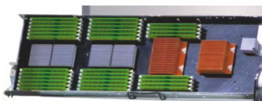
HPs The Machine (mechanisches Muster), nun mit normalen DRAMs: links und Mitte via Fabric angesprochen, rechts lokal mit SoC; Fabric-Switch ganz rechts
