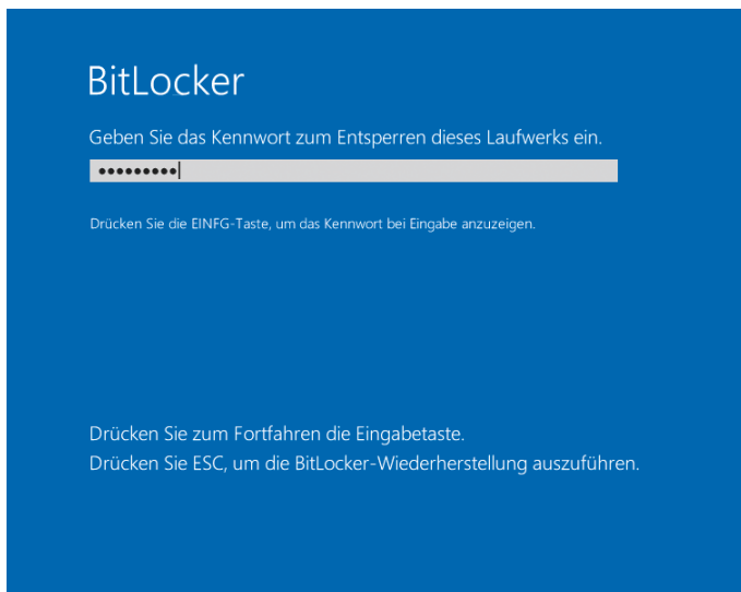
Auch ohne TPM lässt sich Laufwerk C: verschlüsseln – und beim Start zum Beispiel mit Passwort entsperren.
