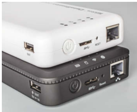
Mit LAN-Buchse und USB-Ladeport: die baugleichen Modelle von Medion und Trekstor
