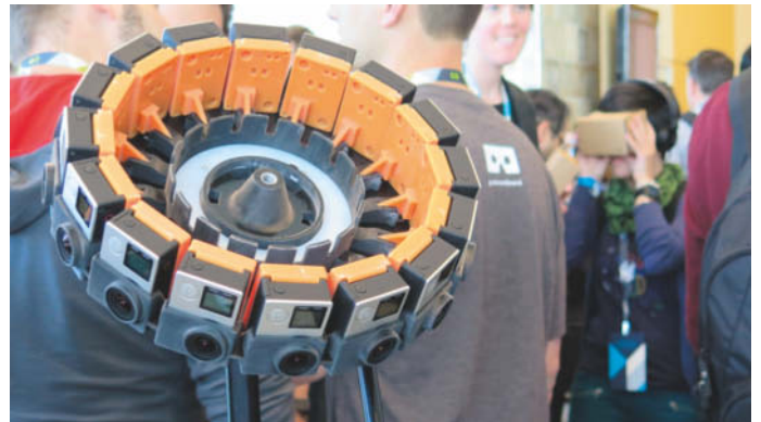
In Googles erster 360-Grad-Kamerahalterung stecken 16 GoPro-Actioncams.
