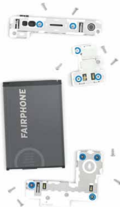
Das Fairphone 2 besteht aus sechs leicht austauschbaren Modulen. Außerdem hat es einen Anschluss für externe Module.
