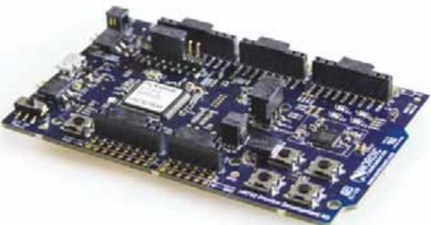
Das nRF52 Preview Development Kit ist ab sofort erhältlich. Wie beim nRF51-Modell lassen sich Arduino-Shields von Drittherstellern einsetzen, die kompatibel zur Uno Revision 3 sind.
