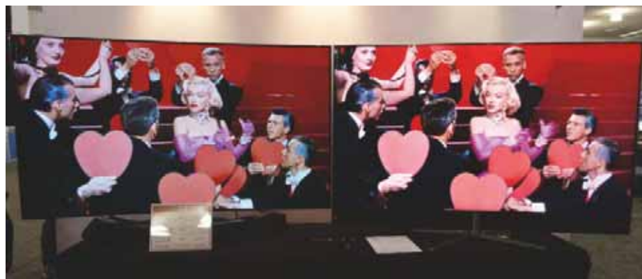
Mit Quantenpunkten im LCD (rechts) steht den farbstarke OLEDs echte Konkurrenz ins Haus.
