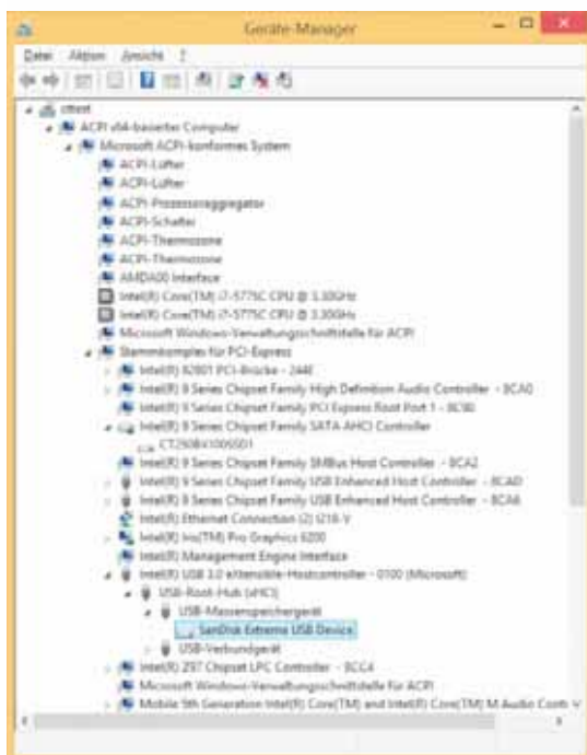
In der „Ansicht nach Verbindung“ verrät der Geräte-Manager, an welchem Controller tatsächlich ein Gerät (und welches) angeschlossen ist.
