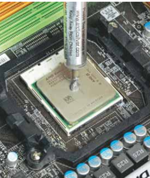
Kontaktstörungen in der Prozessorfassung behebt oft ein kurzzeitiger Aus- und Wiedereinbau der CPU, aber dann ist frische Wärmeleitpaste nötig.
