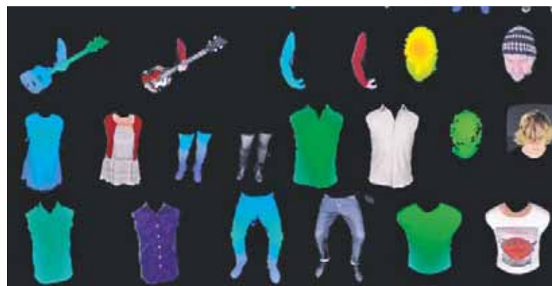
Ein Screenshot aus dem Clip mit nebeneinanderliegenden Tiefen- und Farbinformationen. Der Vertex-Shader erzeugt 3D-Punkte, der Pixel-Shader legt Farbwerte darüber.
