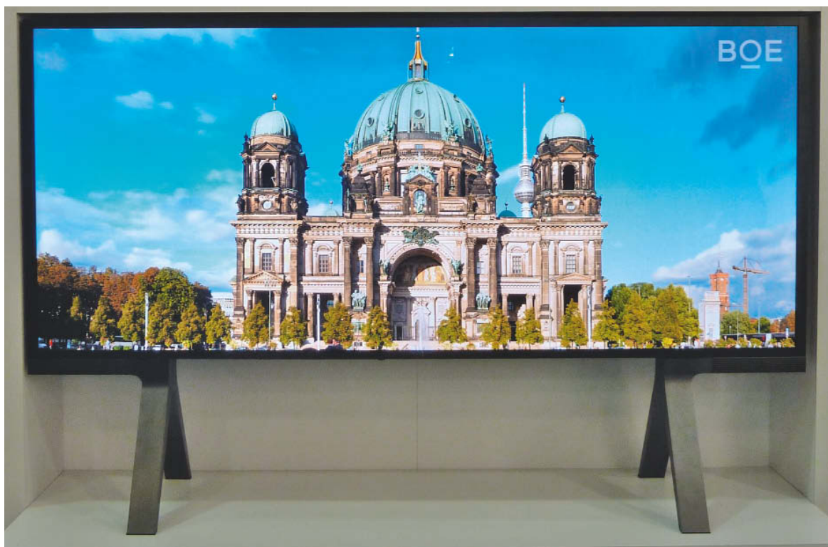
Der chinesische Displayspezialist Boe zeigte auf der Displayweek neben 8K-Displays auch ein überbreites 21:9-LCD mit 10K-Auflösung, also 10240 x 4320 Pixeln. ct
