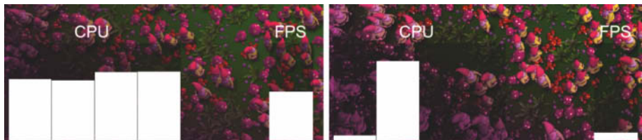
Die Demo Gnome Horde (links) lastet die CPU-Kerne unter Vulkan (links) besser aus und erreicht eine deutlich höhere Framerate als unter OpenGL ES (rechts).
