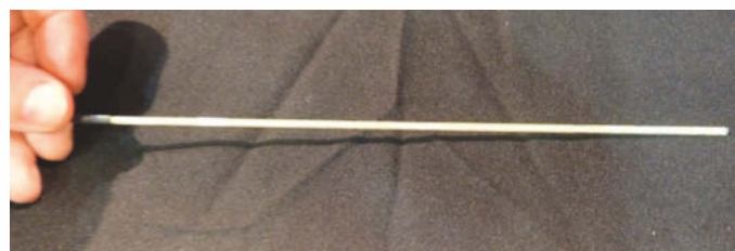
QD Vision bringt die Nanopartikel in einem Glasstab unter, der direkt an die LEDs des Edge-Backlights platziert wird.
