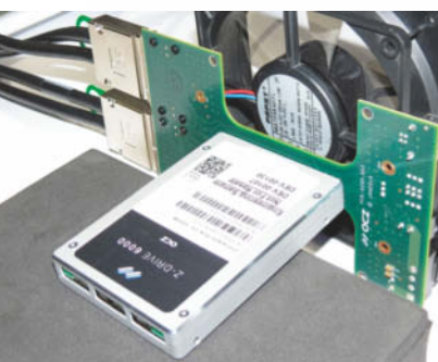
In einer Dualport-Konfiguration liefert das OCZ Z-Drive Daten gleichzeitig an zwei Rechner aus. Die Gesamtdatenübertragungsrate sinkt kaum.
