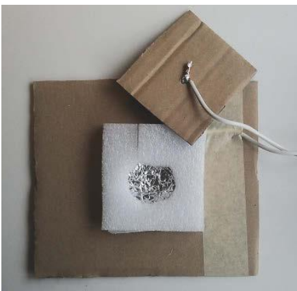
Abb. 8.10: Zwischen Grundplatte und Schaltfläche ist eine Platte aus Schaumgummi mit einem Loch in der Mitte.
