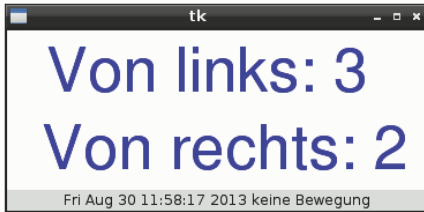
Abb. 10.5: Die Applikation zählt die Personen, die von rechts oder von links durch das Bildfeld der Kamera gelaufen sind.
