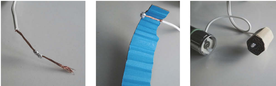
Abb. 1.12: Anschluss eines Steuerkabels an die Taschenlampe
