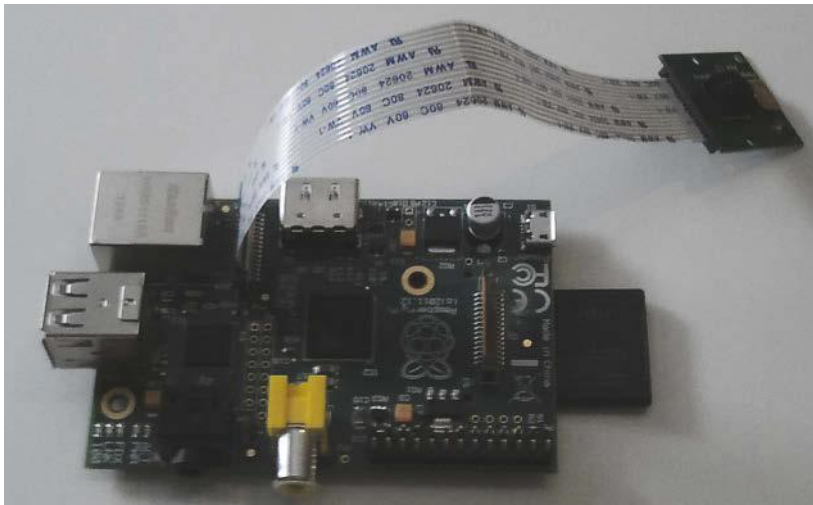
Abb. 10.1: Raspberry Pi mit Kameraplatine
