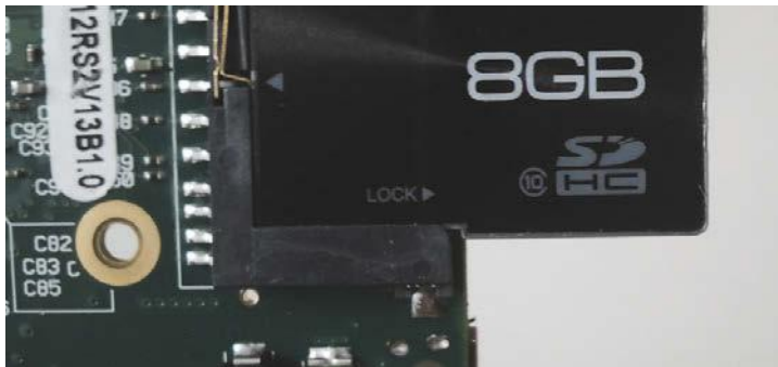
Abb. 6.1: SDHC-Karte der Klasse 10 im Raspberry Pi
