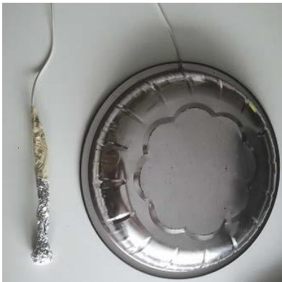
Abb. 7.7: Ein Gong-Schalter aus einem Blechteller und einem Schlegel aus Alufolie
