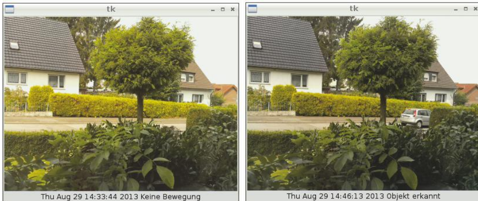
Abb. 10.4: Anwendungsfenster eines Programms, das vorbeifahrende Autos erkennt
