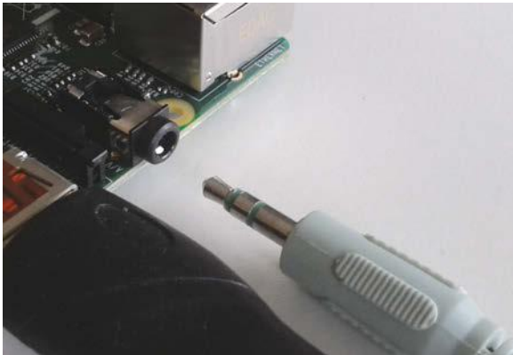
Abb. 3.9: Klinkenstecker und analoger Audio-Ein- und Ausgang des RPi
