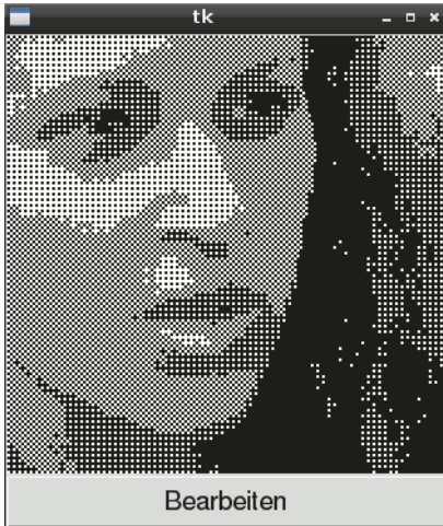
Abb. 5.18: Rasterbild mit fünf Graustufen
