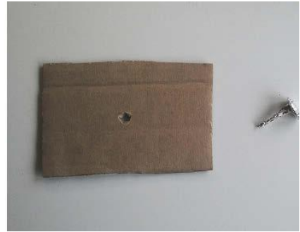
Abb. 8.9: Die Grundplatte des Fußschalters (links) und die bewegliche Schaltfläche (rechts)
