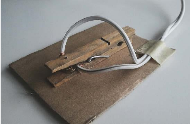
Abb. 2.9: Tastschalter aus einer Wäscheklammer und zwei Reißnägeln (Bauzeit 1 min).
