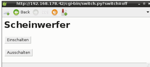
Abb. 11.10: Eine Webseite mit zwei Schaltflächen zum Steuern eines Geräts
