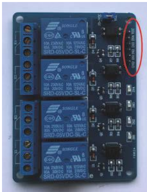
Abb. 1.9: 5-Volt-Relais-Modul für den Arduino. Es funktioniert auch mit dem RPi.
