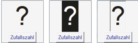
Abb. 5.2: Das Aussehen eines Labels konfigurieren
