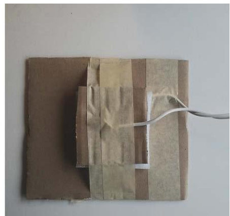
Abb. 8.10: Zwischen Grundplatte und Schaltfläche ist eine Platte aus Schaumgummi mit einem Loch in der Mitte.
