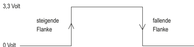
Abb. 2.11: Flanken eines digitalen Signals (Rechteckimpuls)
