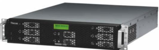
In beiden Geräten stecken jeweils Intels 3,3 GHz schneller Zweikern-Prozessor Core i3-2120 und 8 GByte an DDR3-Speicher mit ECC-Fehlerkorrektur. Eine 10-Gigabit-Ethernet-Karte ist eingebaut; zwei Gigabit-LAN-Adapter sitzen direkt auf dem Mainboard. Alle drei Netzwerkschnittstellen lassen sich bündeln. Sechs USB-2.0-Anschlüsse und zwei USB-3.0-Ports binden externe Geräte wie Festplatten oder Drucker an. Ein Monitor lässt sich lokal per HDMI oder VGA anschließen.
