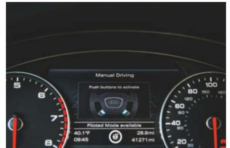
Über das Info-Display wird der Fahrer zur Übernahme aufgefordert. Die zwei Pilot-Tasten erscheinen im Kombiinstrument.
