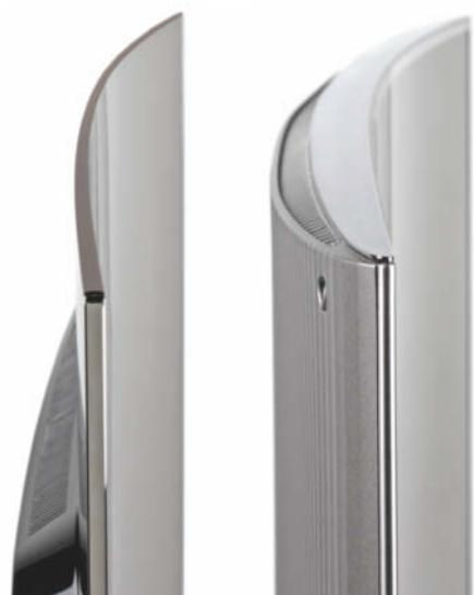
Das OLED-Display, hier im Vergleich zu einem ebenfalls schlanken LCD-TV, ist nur acht Millimeter dünn.
