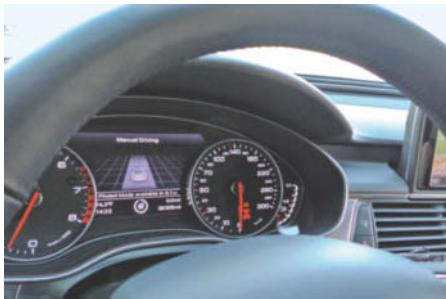
Das Fahrzeug kündigt die Verfügbarkeit des Autobahn-Piloten bereits zwei Minuten vorab an.
