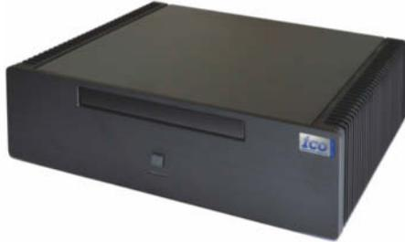
Der ICO T51A wird seine Abwärme über seitliche Kühlrippen los und braucht keinen Lüfter.
