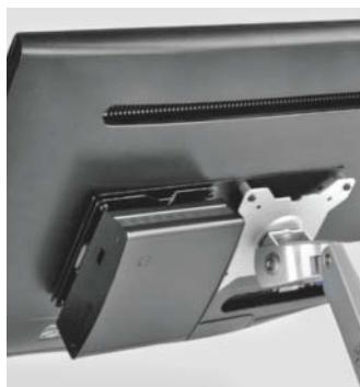
Mit der VESA-Halterung MVA01 von Silverstone passen Schwenkarm und Mini-PC zugleich an einen Monitor.
