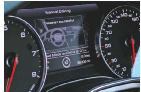
Durch das Drücken der Pilot-Knöpfe oder einen Eingriff an Pedalerie oder Lenkrad erhält man die Kontrolle zurück.
