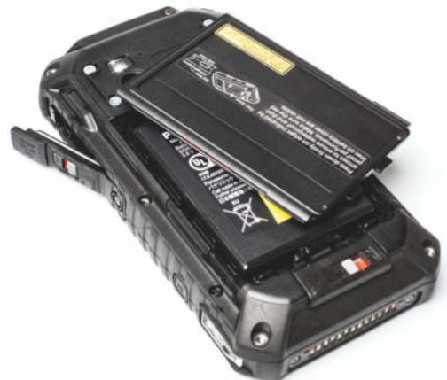
**Der Akku des Panasonic Toughpad ist im laufenden Betrieb wechselbar; die Kamera-LED weist im Dunkeln den Weg.**
