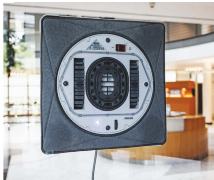
den Nutzer an der Scheibe klebt – etwa, weil er grade am oberen Ende der Scheibe arbeitet – lässt sich der Winbot W930 auch im Akku-Notbetrieb mit Hilfe der Fernbedienung in eine erreichbare Position navigieren.
