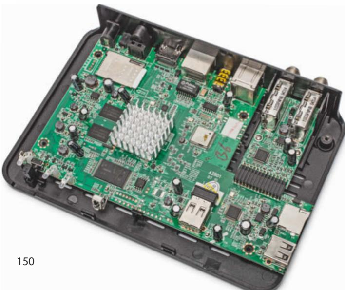
Die Wetek-Box vereint Mediacenter, TV-Receiver und digitalen Videorecorder: Es gibt sie mit Doppel-Tuner für DVB-S2 und für DVB-C sowie DVB-T/T2.
