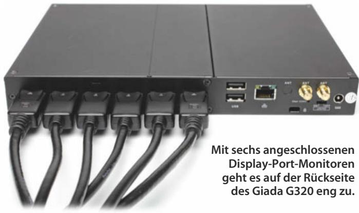
Mit sechs angeschlossenen Display-Port-Monitoren geht es auf der Rückseite des Giada G320 eng zu.
