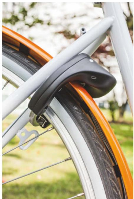
Fehlt die Platte, hilft ein separat zu erwerbender Adapter bei der Montage. Das Gehäuse des Schlosses wird aus einem glasfaserverstärkten Kunststoff gefertigt und ist verschweißt, um Aufbruchsversuchen länger standhalten zu können. Der Schließbügel besteht aus gehärtetem Stahl und wird über einen Motor bewegt. Optional kann das Schloss mit einem Stahlkabel erweitert werden, um das Rad an feste Gegenstände anzuschließen.
