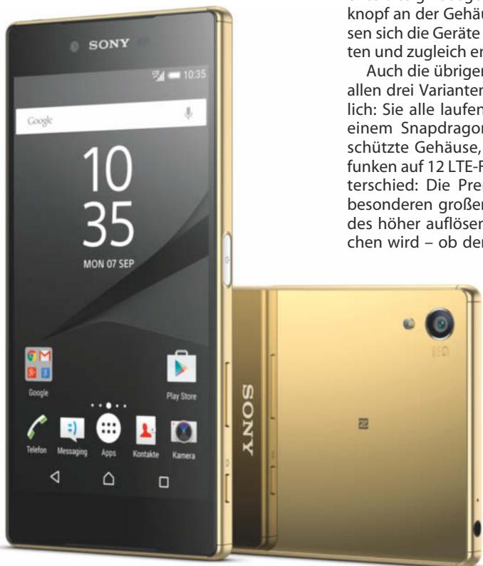
Das Sony Xperia Z5 Compact, das Xperia Z5 und das Xperia Z5 Premium (Bild) haben Fingerabdrucksensoren in den Ein-/Ausschaltern integriert.
