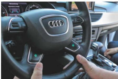
Durch einen kurzen Druck auf die zwei Pilot-Tasten am Lenkrad gibt man die Fahrverantwortung ab.
