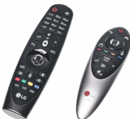
Dem 55EG9609 liegt eine Kombifernbedienung bei, in der wie in der kleineren des 55EC930V ein Gyroskop steckt.
