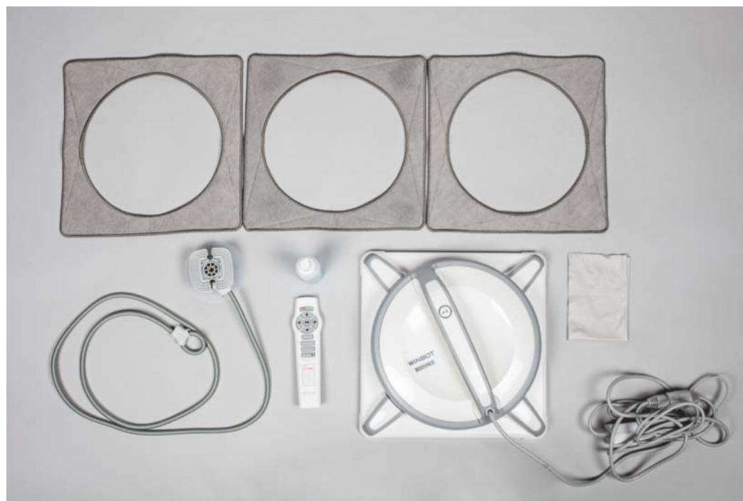
Der Winbot W930 fährt senkrechte Glasflächen automatisch ab, kann bei Bedarf aber auch via Fernbedienung über die zu reinigende Fläche dirigiert werden.
