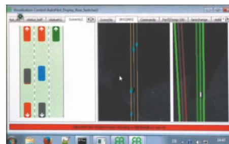
Im Testwagen lässt sich ein Diagnose-Screen auf den Navi-Bildschirm legen. In ihm können die Entwickler alle einlaufenden Sensordaten in Echtzeit verfolgen.
