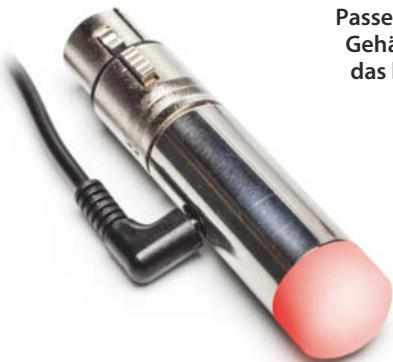
Passen genau in ein handelsübliches Gehäuse: die Funkplatine oben und das kleine Schaltnetzteil, das 5 Volt mit bis zu 600 mA liefert.
