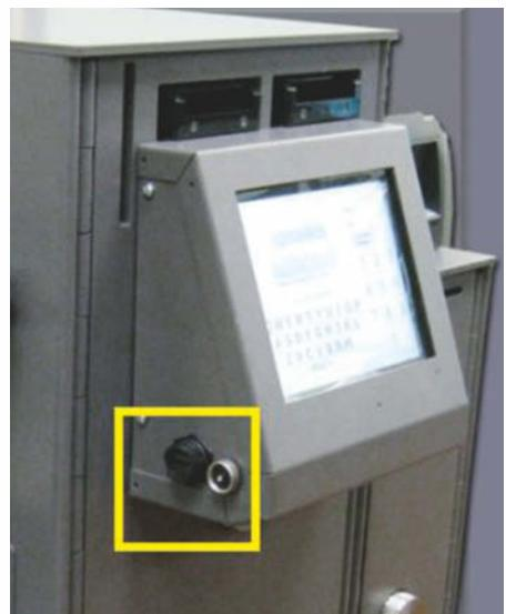
Safe mit Hintertür: Um den Compusafe Galileo zu knacken, braucht man kein schweres Werkzeug, sondern nur einen präparierten USB-Stick. Der Wartungspunkt ist an der Seite, für jedermann zugänglich.
