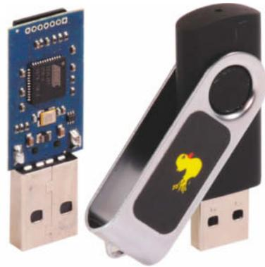
**Rubber Ducky** sieht wie ein harmloser USB-Stick aus, kann aber eine USB-Tastatur simulieren und so fremde Rechner kapern.
