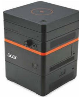
An den Acer Revo Build – der mittlere Teil mit orangefarbenem Deckel – lassen sich oben und unten Erweiterungsmodule anstecken.
