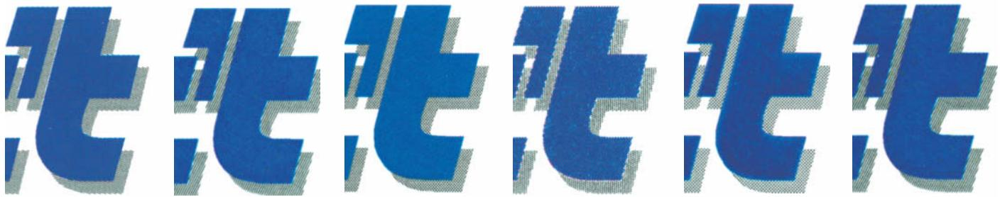
Laserdrucker rastern deutlich größer als Tintendrucker. Mitunter sieht man auch mit bloßem Auge an geraden Kanten feine Stufen (von links nach rechts: Brother, Dell, HP, Ricoh, Samsung und Xerox).
