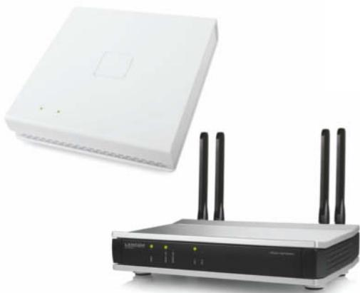
Lancoms Access Points L-822acn und LN-830acn funkten über ihre vier Antennen mit bis zu 867 MBit/s brutto im 5-GHz-Band; im 2,4-GHz-Band erreichen sie maximal 300 MBit/s brutto.
