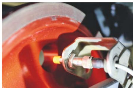
Ein induktiver Sensor zählt die Löcher im Rad – damit weiß das VR-System immer, auf welcher Position sich der Achterbahn-Waggon gerade befindet.
