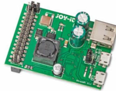
StromPI dient als batteriegepufferte USV oder als besonders kräftige Spannungsquelle, nicht nur für Raspis.
