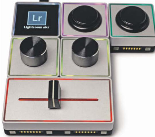
Das Palette Gear umfasst vier Modultypen: das quadratische Core-Modul mit Display, die ebenfalls quadratischen Modultypen für Buttons und Drehregler sowie die doppelt so breiten für Schiebereglern. An je zwei Seiten der Module sitzen Pins, an den anderen Kontakte. Per Magnet lassen sie sich einfach kombinieren. So liegt das Gear bald zusammengefummelt da. Aber eins nach dem anderen.
