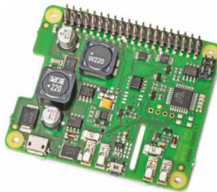
Nutzt und lädt Lithium-Ionen Akkus und kommt mit fertiger Software für den USV-Betrieb: PiUSV+ für alle neueren Raspis
