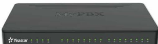
In die VoIP-Tk-Anlage MyPBX Standard von Tiptel lassen sich bis zu acht Erweiterungsmodul für analoge und ISDN-Telefone oder Mobilfunkmodule einbauen.
