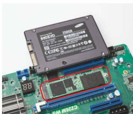
Solid-State Disks in M.2-Bauform können unterschiedliche Schnittstellen und Protokolle nutzen.
