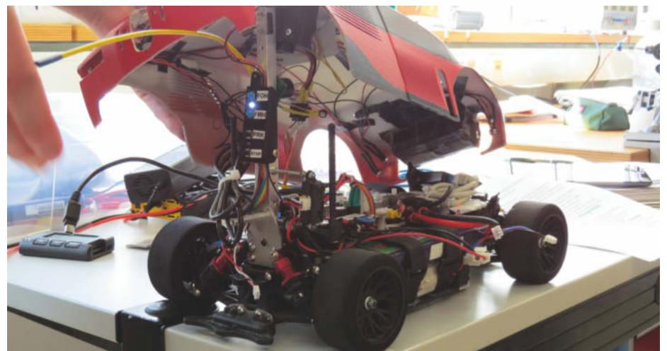
Beim Finale trägt das Auto eine passgenaue Haube, die das Phoenix-Robotics-Team selbst in CAD entwirft.
