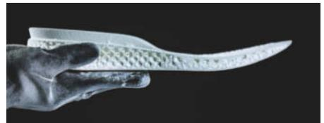
**Passgenau:** Adidas experimentiert mit Turnschuh-Sohlen aus dem 3D-Drucker.
