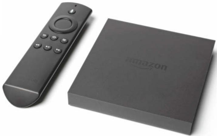
Auf den ersten Blick gleicht das neue Fire TV dem alten: Im Karton liegt ein quadratisches schwarzes Kistchen mit 11,5 cm Kantenlänge und 1,8 cm Höhe. An der Rückseite hat der optische Digitalausgang des Vorgängers einem Speicherkarteneinschub für MicroSD-Karten Platz gemacht.
