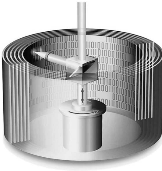
Bild 5: „Tesa-ROM“-Datenspeicher (Modell): Ein Minilaser rotiert im Innern einer Tesarolle und schreibt digitale Hologramme in die Tesaschichten
