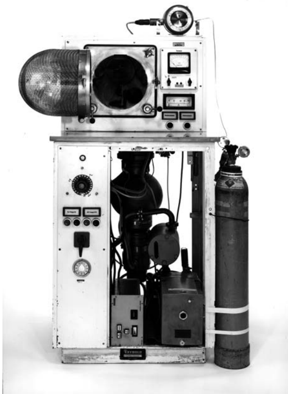
Bild 1: Kohlenstoffverdampfungsanlage, mit der am MPI für Kernphysik in Heidelberg die Produktion von Fullerenen gelang (heute im Deutschen Museum in Bonn)
