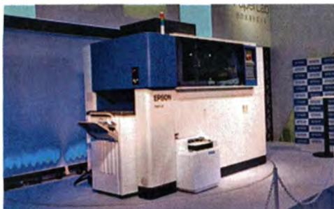
Das PaperLab von Epson zerfasert Altpapier und produziert daraus Recycling-Papier bis DIN-A3; Größe und Dicke lassen sich einstellen.
