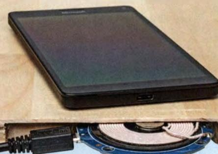
Telefon zum Laden liegen soll. Doch der Qi-Standard hält dafür eine pfiffige Lösung parat: Im Zentrum der Sendespule darf ein Magnet sitzen – Nordpol nach oben. In vielen Telefonen steckt bereits das passende Gegenstück. Wir haben einen Scheibenmagnet aus Neodym mit 13 mm Durchmesser und 2 mm Dicke in die Sendespule gelegt und waren verblüfft, wie intuitiv man damit die ideale Ladeposition findet – trotz der eigentlich geringen Kräfte. Das klappt übrigens auch im Originalgehäuse.
