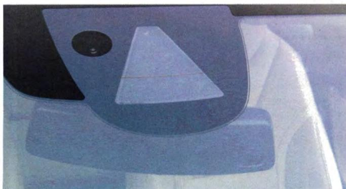
**Die Frontkamera nutzt der Autopilot des Model S vor allem für die Spurführung.**
