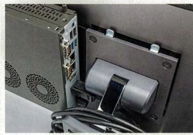
**Mit einer VESA-Adapterplatte lassen sich Mini-Rechner und PC-Monitor zu einem All-in-One-PC verheiraten. Durch die verstellbare Befestigung des Shuttle DH170 gibt es genug Platz hinter den Anschläßen.**
