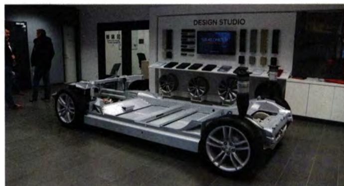
**Die mehr als 6500 Lithium-Ionen-Akkus sind unter der gesamten Fahrgastzelle zwischen Vorder- und Hinterachse montiert.**
