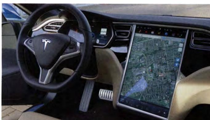
Das 17-Zoll-Touchscreen-Display ist die zentrale Bedieneinheit des Tesla Model S. Dahinter sitzt ein Embedded-PC.
