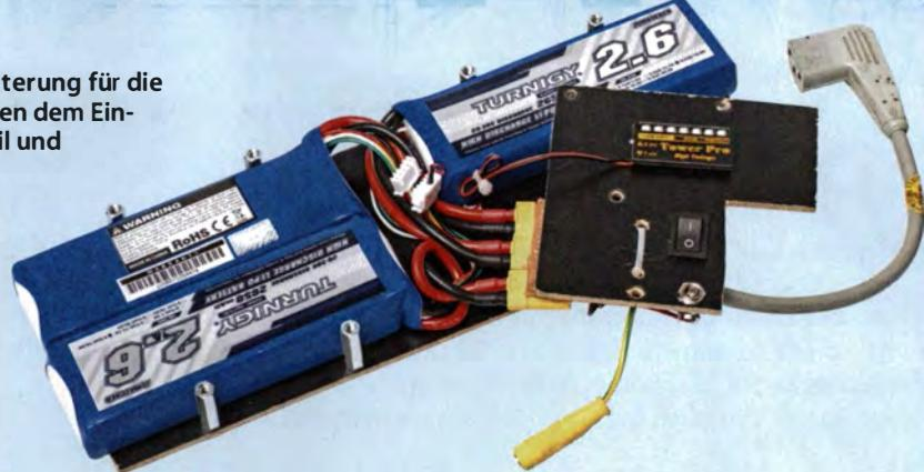
über den Schutzkontakt des Kaltgeräteanschlusses erden müssen. Dazu haben wir am Anschlusskabel eine Bananenbuchse zum Anschluss einer Erdungsleitung montiert.
