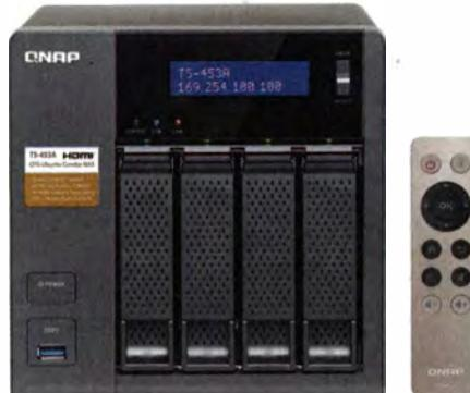
Beim QNAP TS-453A läuft Linux in einem LXC-Container isoliert vom NAS-Betriebssystem QTS.
