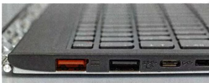
Das Yoga 900 wird über eine USB-2.0-Buchse im modifizierten Typ-A-Format (links) geladen. Die neue Typ-C-Buchse (rechts) stellt wahlweise USB-3.0- oder DisplayPort-Signale zur Verfügung.
