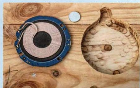
Laut Qi-Standard dürfen zwischen Oberfläche und Sendespule maximal 2,5 mm liegen. Das restliche Material der Tischplatte muss weg. Platz für einen Magneten ist aber allemal.
