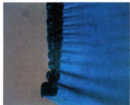
Der Schnitt durch ein mit dem FDM-Verfahren gefertigtes 3D-Modell zeigt in der Vergrößerung deutlich den schichtweisen Aufbau aus einem Filamentfaden.
