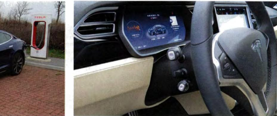
**Durch zweimaliges Heranziehen des unteren Schalt-hebels auf der linken Lenkrad-Seite aktiviert man den Autopilot des Model S.**
