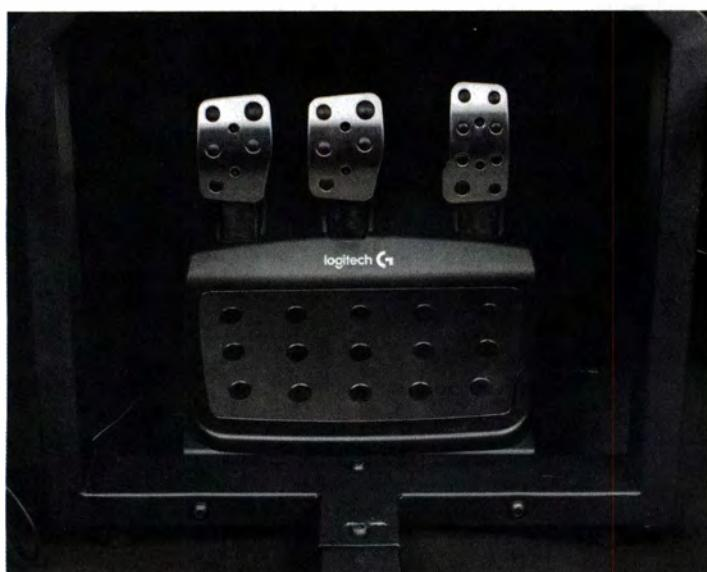
Die Pedale für den Simulator schraubt man am Stuhl an. Dann verrutscht oder wackelt auch bei einer Vollbremsung nichts.
