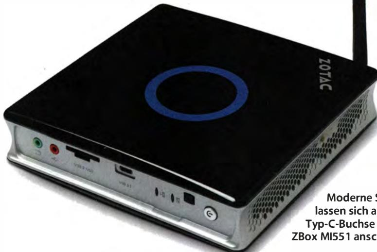
Moderne Smartphones lassen sich an der USB-Typ-C-Buchse der Zotac ZBox MI551 anschließen.
