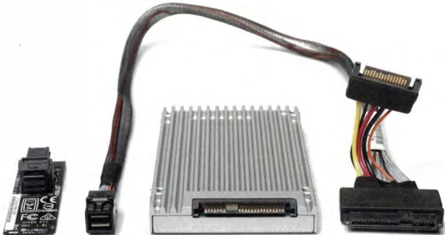
**U.2-SSDs sind dicker als 2,5-Zoll-SATA-SSDs und besitzen oft Kühlrippen; Intels SSD 750 kommt mit einem Kabel, das auf spezielle M.2-Adapter passt.**
