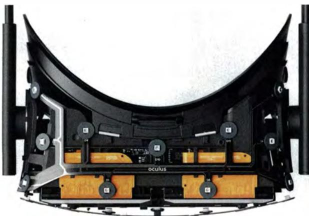
Um die Kopfbewegung des Trägers zu erkennen, erfasst eine externe Tracking-Kamera die kleinen LEDs in der Oculus Rift (im Bild 16 Stück sichtbar).
