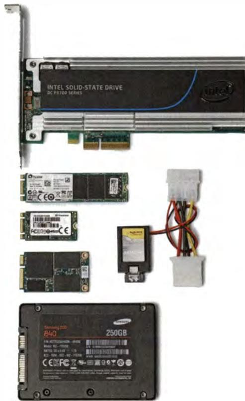
Generation. Immerhin ist PCIe abwärtskompatibel: Eine M.2-SSD mit PCIe 3.0 x4 läuft auch in einem Slot, der nur PCIe 2.0 x2 beherrscht, aber langsamer.
