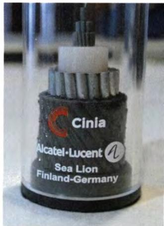
Anhand eines Musters zeigt Alcatel-Lucent den Aufbau des C-Lion-Kabels. Acht dünne Glasfaser-Paare (ganz oben) transportieren die Daten.
