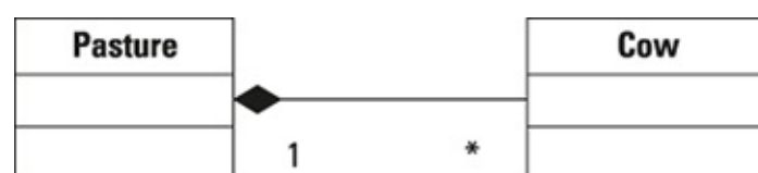
Abbildung 29.3 : Es können viele Instanzen der Klasse mit dem * mit der Klasse mit der 1 verbunden werden.
