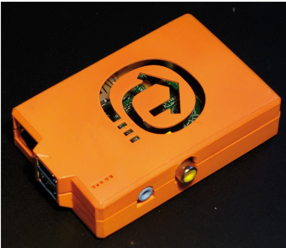
Abbildung 1.2: openHAB läuft auf einem Raspberry Pi als Home-Gateway
