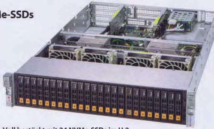
Voll bestückt mit 24 NVMe-SSDs im U.2-Format stellt der SuperServer 2028U-TN-24R4T+ bis zu 48 TByte schnellen Flash-Speicher bereit.
