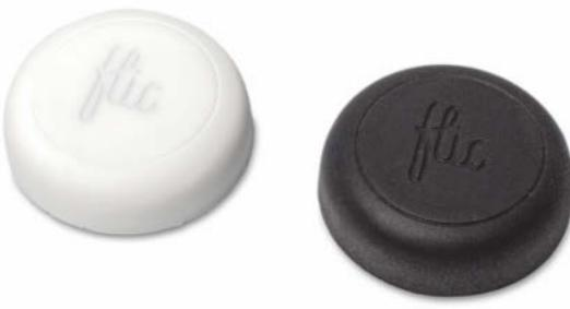
Die „smarten“ Flic-Knöpfe lassen sich mit Doppelklebeband leicht an glatten Oberflächen befestigen.
