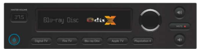
Der AV-Receiver liefert über (W)LAN Statusmeldungen an die Steuerzentrale, die diese auf einer vom Autor selbst gestalteten Weboberfläche visualisiert.
