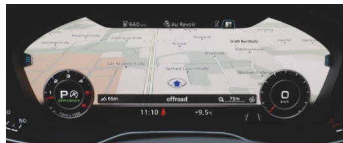
Das kann nur das eingebaute Navi: Der Audi A4 blendet die Karte im virtuellen Cockpit ein und verkleinert dafür Tacho und Drehzahlmesser.
