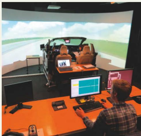
Im HMI-Lab lässt sich das Ablenkungspotenzial verschiedener Bedienkonzepte unter Laborbedingungen testen.
