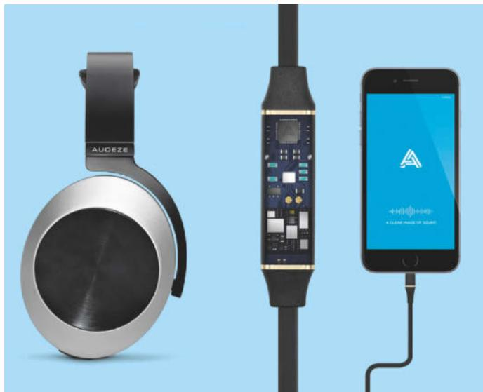
Vorbei an Standardbuchse und integriertem Kopfhörerverstärker koppelt sich der Audeze-Kopfhörer an ein aktuelles iPhone; die Elektronik für den Lightning-Anschluss steckt im Kabelweg.
