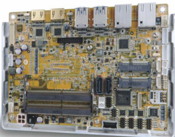
Auf der Rückseite des EPIC NANO-ULT3 von ICP verbirgt sich ein Skylake-Mobilprozessor, der seine Wärme auf den Aluminiumrahmen überträgt.
