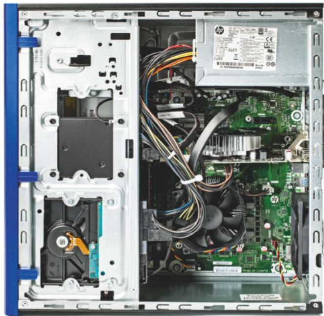
Im HP Pavilion 700 gibt es kaum Aufrüstmöglichkeiten. Sämtliche Laufwerksschächte sind bereits mit SSD und Festplatte belegt.
