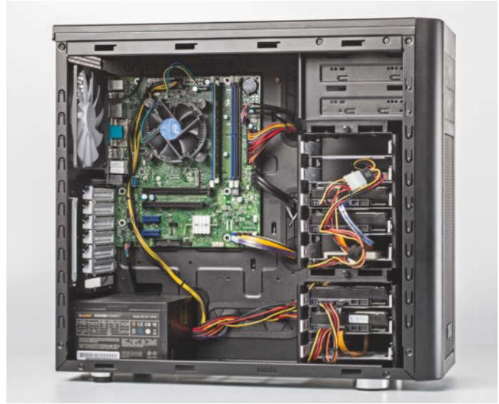
te eingebaut. Das Betriebssystem liegt auf einer 2,5"-SSD mit 32 GByte, sodass sich die Festplatten zwischen den Zugriffen schlafen legen können.
