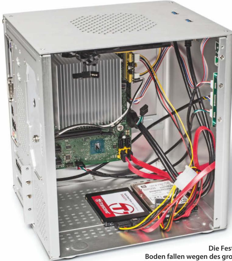
Die Festplatten am Boden fallen wegen des großen Passivkühlers auf dem Prozessor im Inneren kaum auf.
