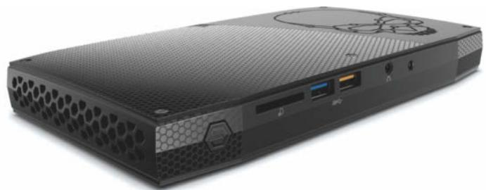
tore steuert der Mini-PC über HDMI 2.0 und DisplayPort 1.2 bei 4K-Auflösung jeweils mit 60 Hz an. Zur weiteren Ausstattung gehören eine Typ-C-Buchse mit Thunderbolt 3, 802.11-ac-WLAN, ein SD-Kartenleser, Gigabit-Ethernet und 4 x USB 3.0.
