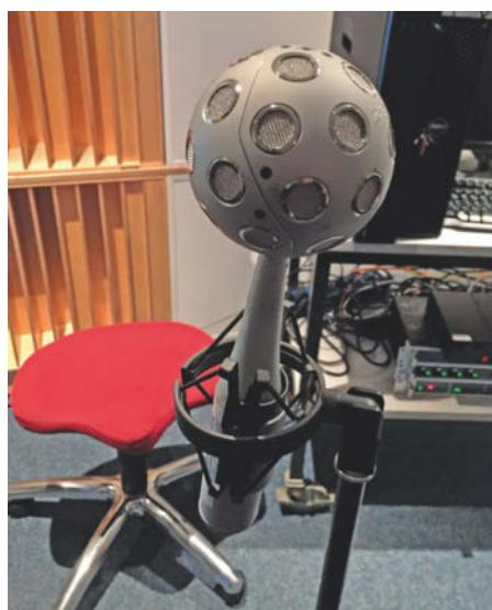
Bei 3D-Klangaufnahmen nach dem HOA-Verfahren kommen Mikrofon-Arrays wie das Eigenmike von MH Acoustics zum Einsatz.
