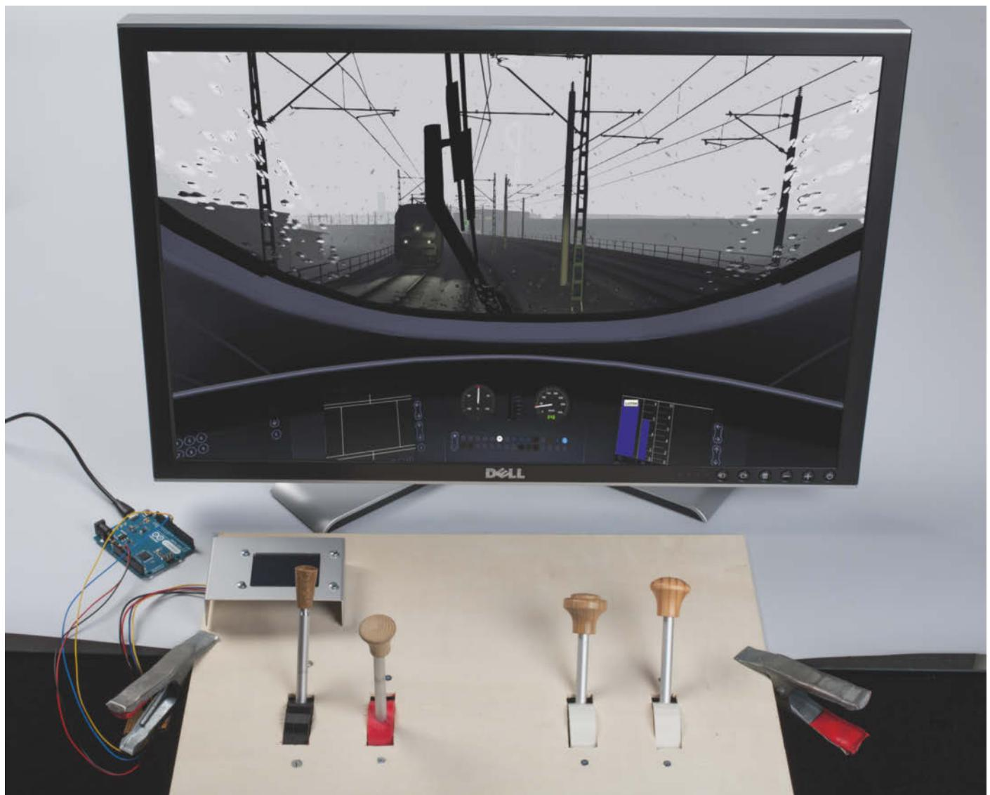
Mit einem Arduino-Leonardo oder kompatiblen Boards kann man recht einfach komplett Steuerhardware für Simulatoren realisieren und je nach Detailverliebtheit und handwerklichem Geschick die Realitätstreue auf die Spitze treiben.
