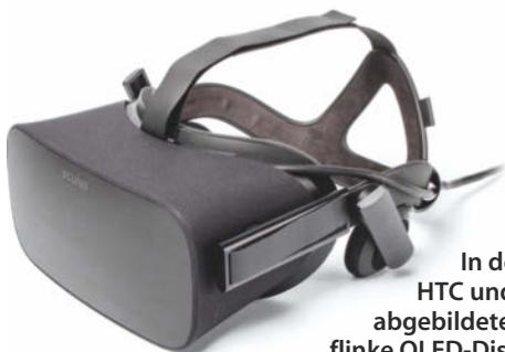
In den VR-Brillen von HTC und Sony sowie der abgebildeten Oculus stecken flinke OLED-Displays.
