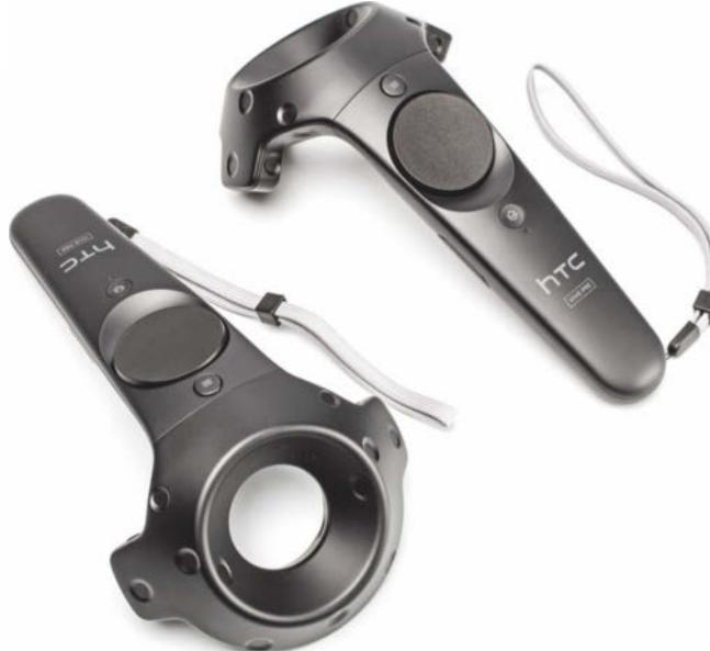
Die Vive-Controller tracken ihre Position im Raum über Fotodioden an den vorderen Ringen. Zur Steuerung hat man ein klickbares Touchpad für den Daumen, einen Abzug für den Zeigefinger sowie zwei Trigger an der Seite für Greifbewegungen.
