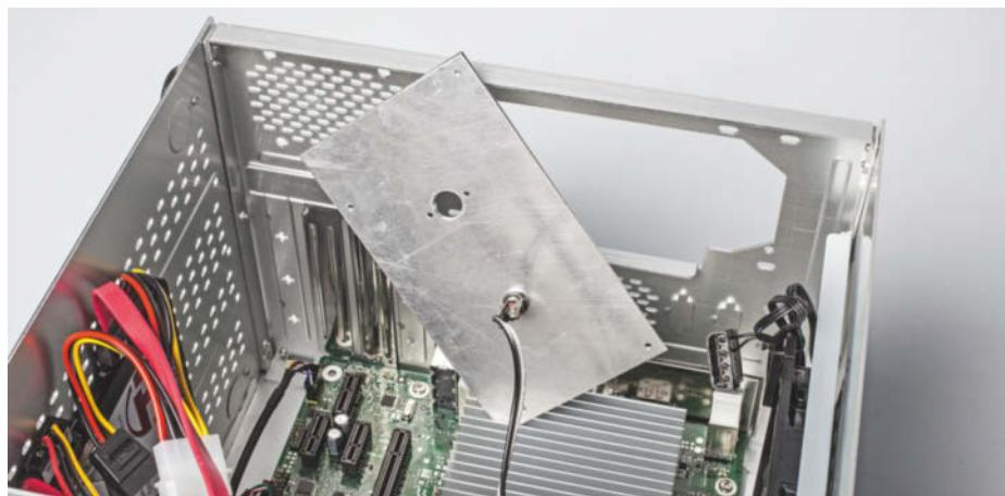
Damit anstelle des ATX-Netzteils kein unschönes Loch im Gehäuse entsteht, haben wir eine passende Blende mit Kabeldurchführung für das PicoPSU-Netzteil besorgt.
