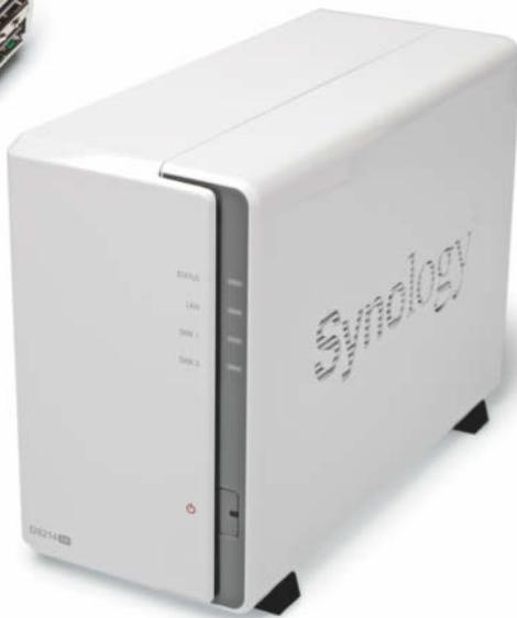
Eine kompakte NAS-Box wie das Synology DS214se braucht im Leerlauf mit Platten nur 8 Watt, hat aber wenig RAM und Rechenleistung.
