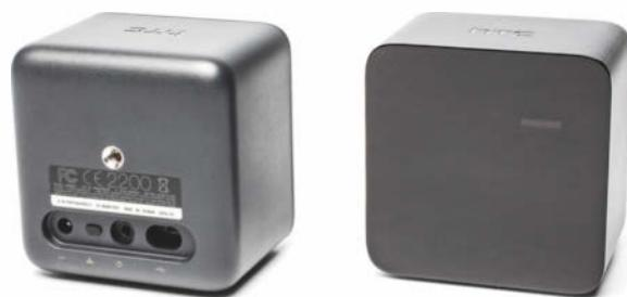
Die beiden Lighthouse-Würfel der Vive spannen auf 4 bis 12 m<sup>2</sup> ein unsichtbares Laser-Netz auf, mit dem die Vive-Brille und Controller ihre Raumposition ermitteln.
