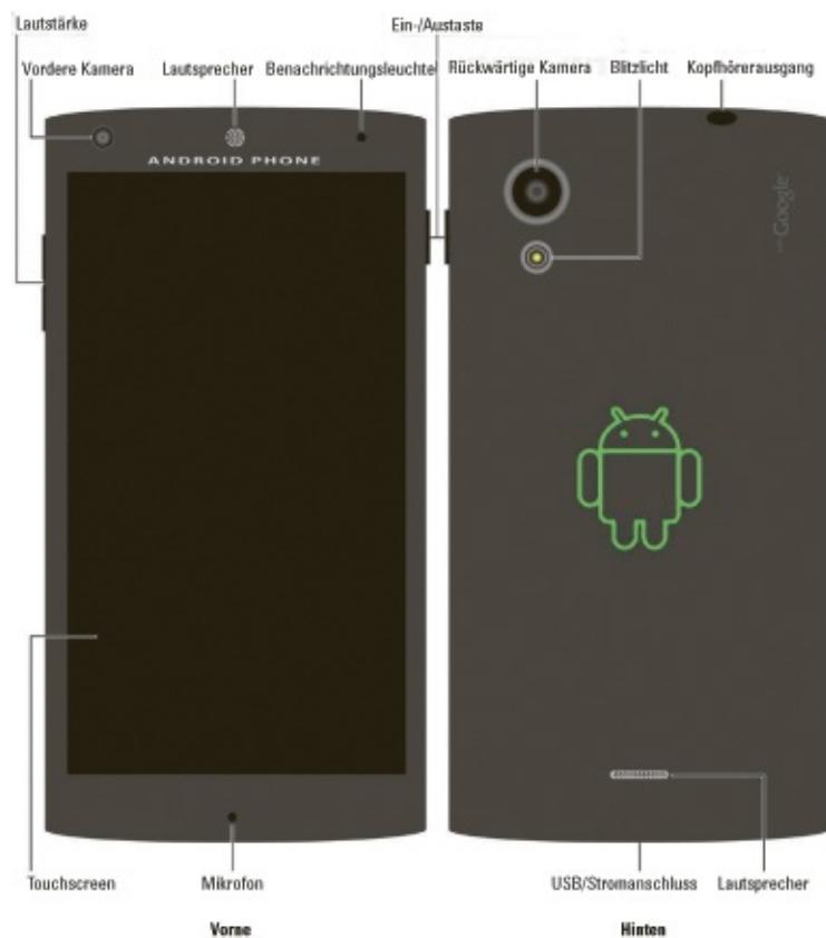
[Abbildung 1.2](#): Vorder- und Rückseite eines Smartphones
