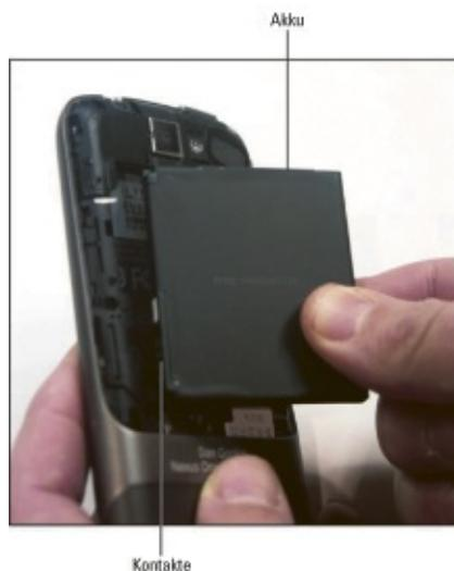
[Abbildung 1.1](#): Den Akku einsetzen
