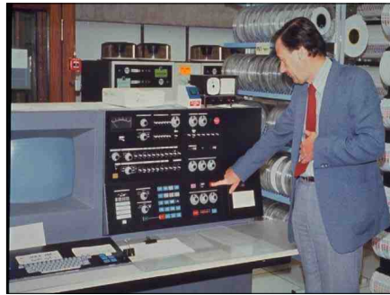
Bereits 1972 konnte der IBM 370/165 Hardware-gestützte, virtuelle Maschinen starten und nutzte dazu erstmals Virtual Memory Management.
