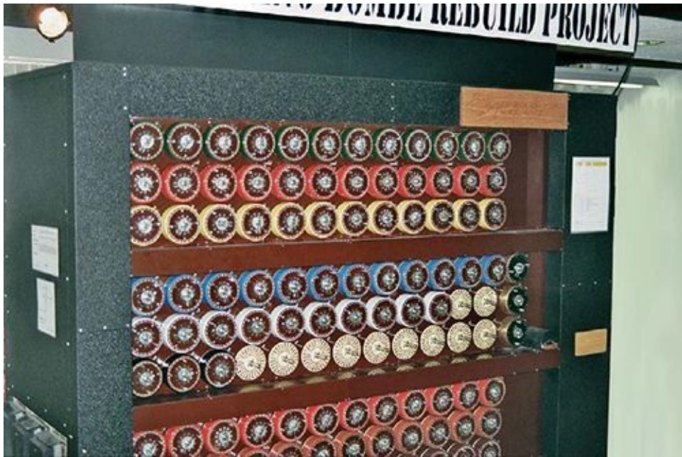
Abb. 5-5 Mit der Turing-Bombe knackten die Briten die Enigma.
