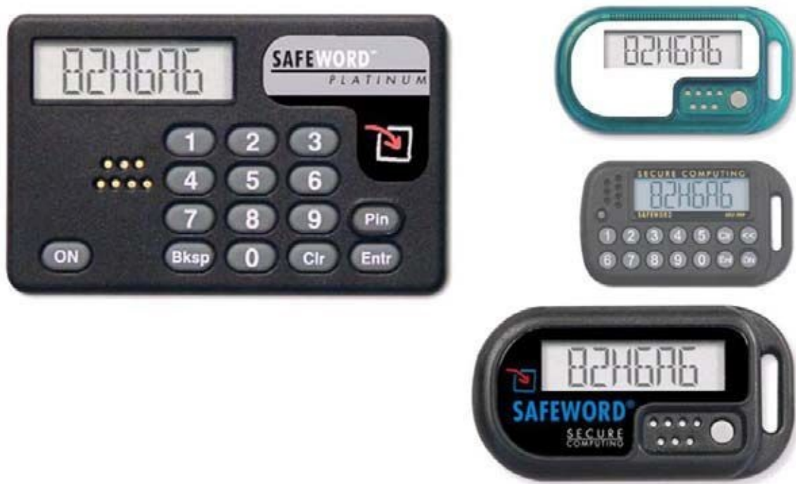
Abb. 26–8 Eine Auswahl von OTP-Tokens der Firma Secure Computing
