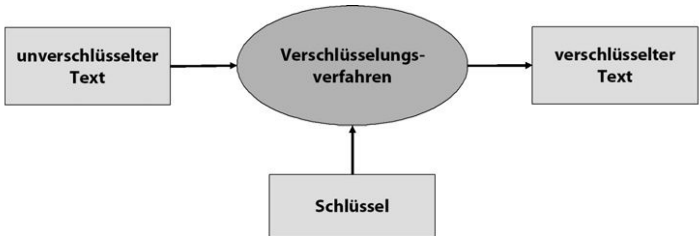
Abb. 4-1 Bei einem guten Verschlüsselungsverfahren geht ein Schlüssel (eine Art Passwort) in die Verschlüsselung ein.
