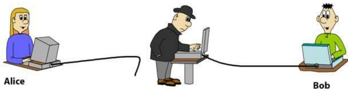
Abb. 25–5 Bei einer Hijacking-Attacke übernimmt Mallory eine Verbindung von Alice.
