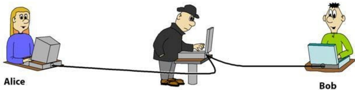
Abb. 25–4 Bei einer Man-in-the-Middle-Attacke greift Mallory aktiv in die Kommunikation zwischen Alice und Bob ein.
