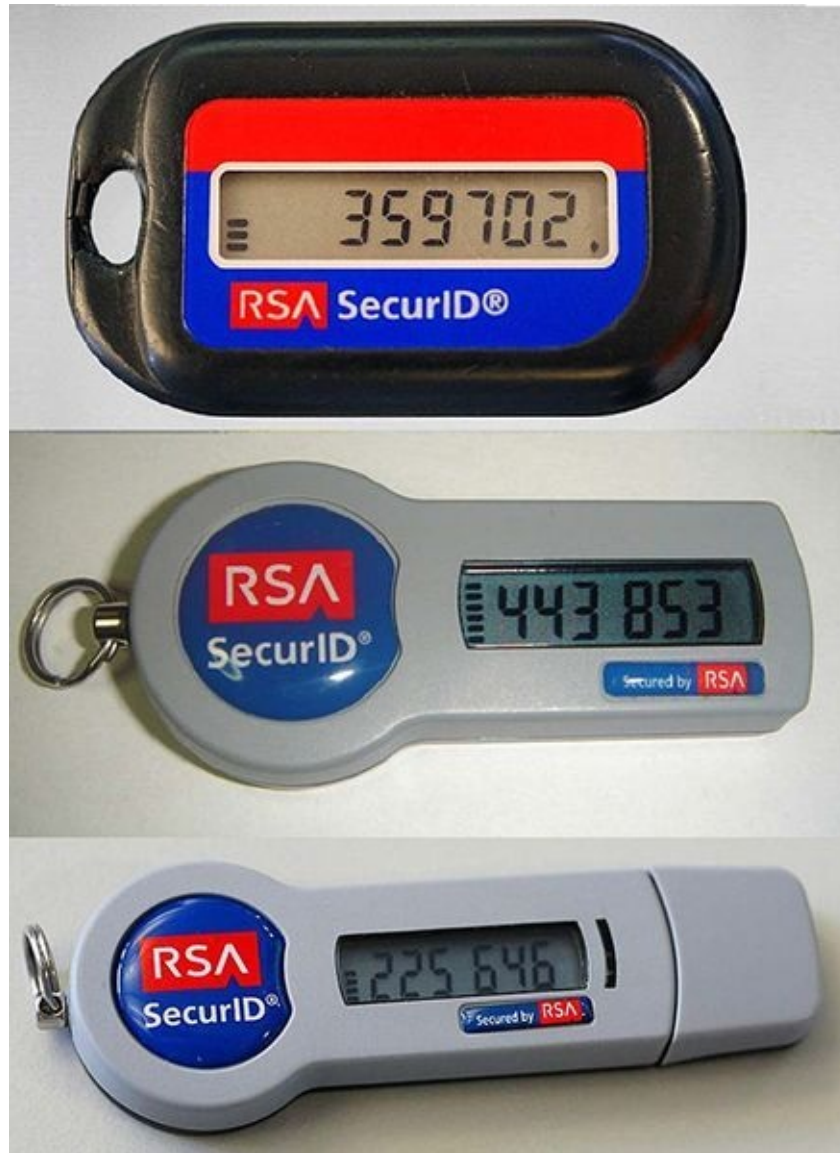
Abb. 26–7 Die SecurID-Karte (hier in verschiedenen Varianten) ist das bekannteste OTP-Token und außerdem eines der erfolgreichsten Krypto-Produkte überhaupt.
