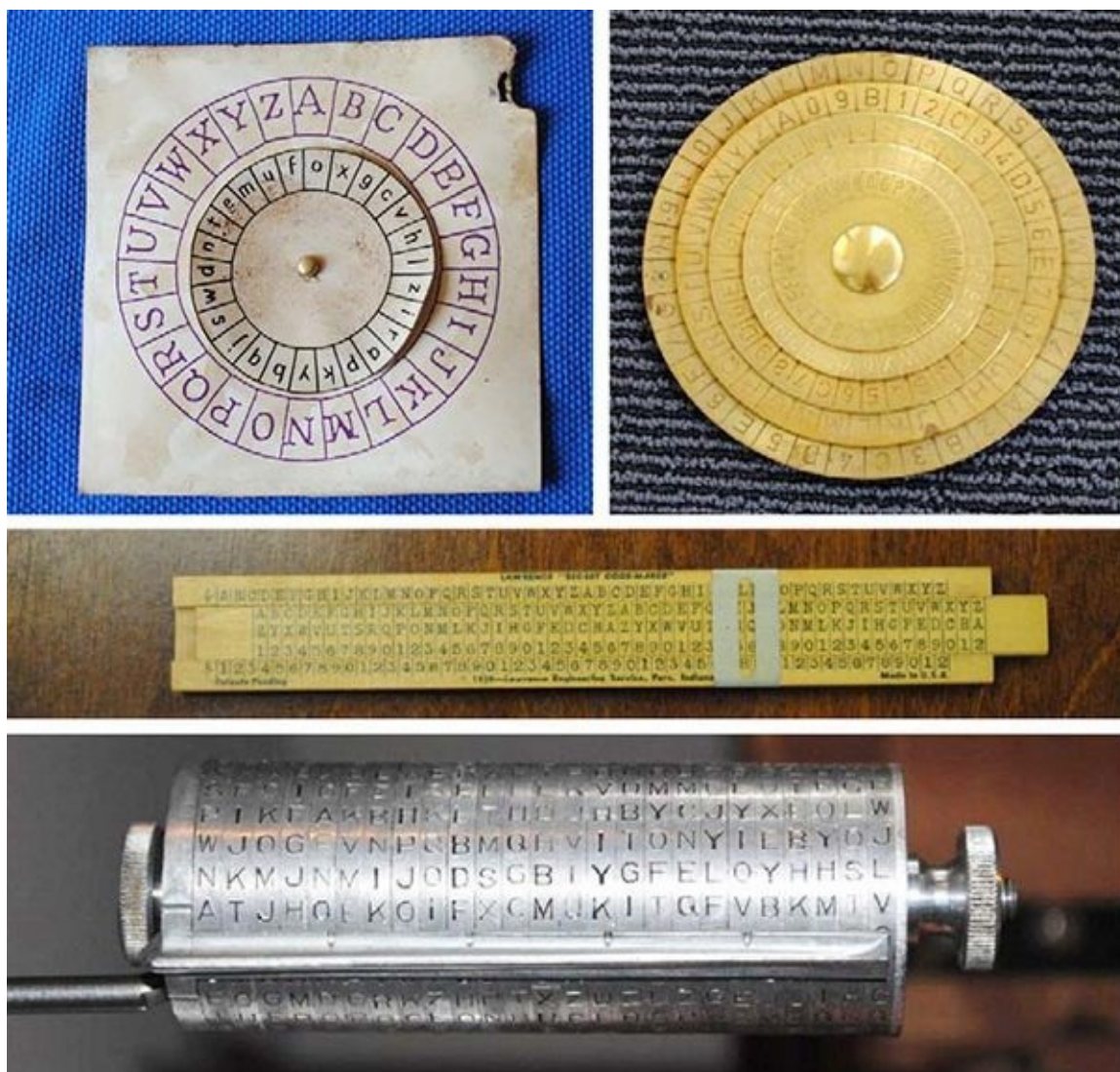
Abb. 5–1 Chiffrierscheiben gibt es mit zwei (oben links) und mehr Reihen (oben rechts). Nach einem ähnlichen Prinzip funktionieren Chiffrierschieber (Mitte) und Chiffrierzylinder (unten).
