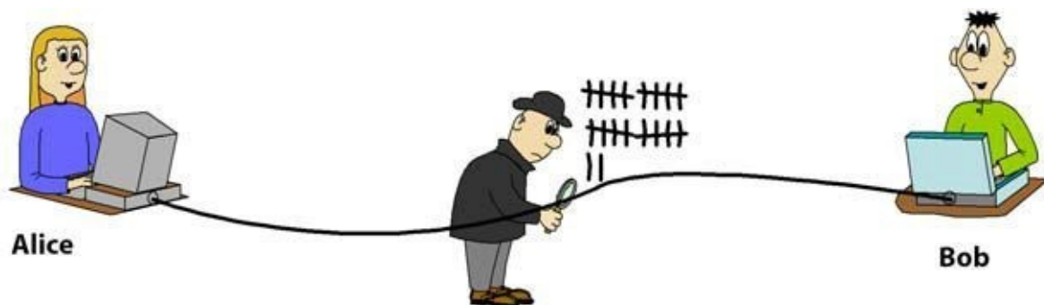
Abb. 25–6 Bei einer Verkehrsflussanalyse kennt Mallory nur Sender und Empfänger, nicht aber den Inhalt der Nachrichten.
