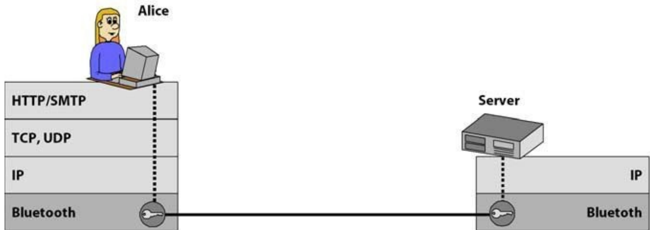
Abb. 40–4 Bluetooth ist eine Technologie für die drahtlose Datenübertragung über kurze Strecken. Kryptografie ist fest eingebaut.
