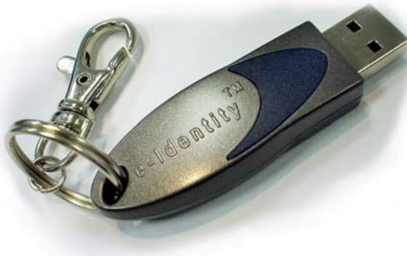
Abb. 28–3 Ein USB-Token funktioniert wie eine Smartcard, benötigt jedoch keinen Kartenleser.
