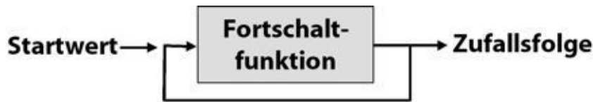
Abb. 19–1 Bei einem Pseudozufallsgenerator wird ein Startwert sukzessiv fortgeschaltet.
