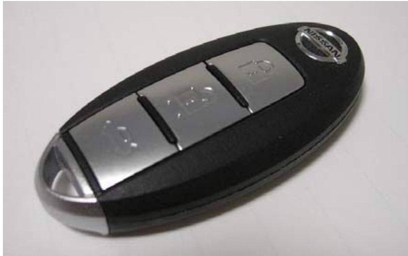
Abb. 28–4 Ein Autoschlüssel ist heute meist als Smart Token realisiert, das ein Challenge-Response-Verfahren ausführt.
