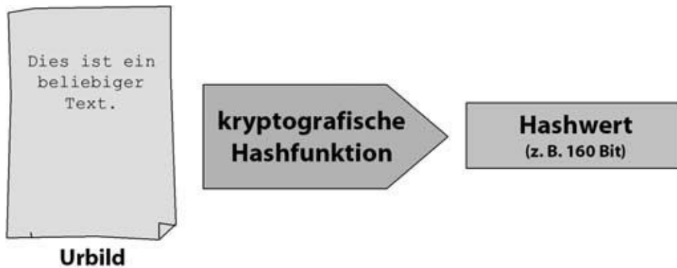
Abb. 16–1 Statt eines ganzen Texts wird in der Praxis nur ein Hashwert signiert. Dieser wird mit einer kryptografischen Hashfunktion gebildet.
