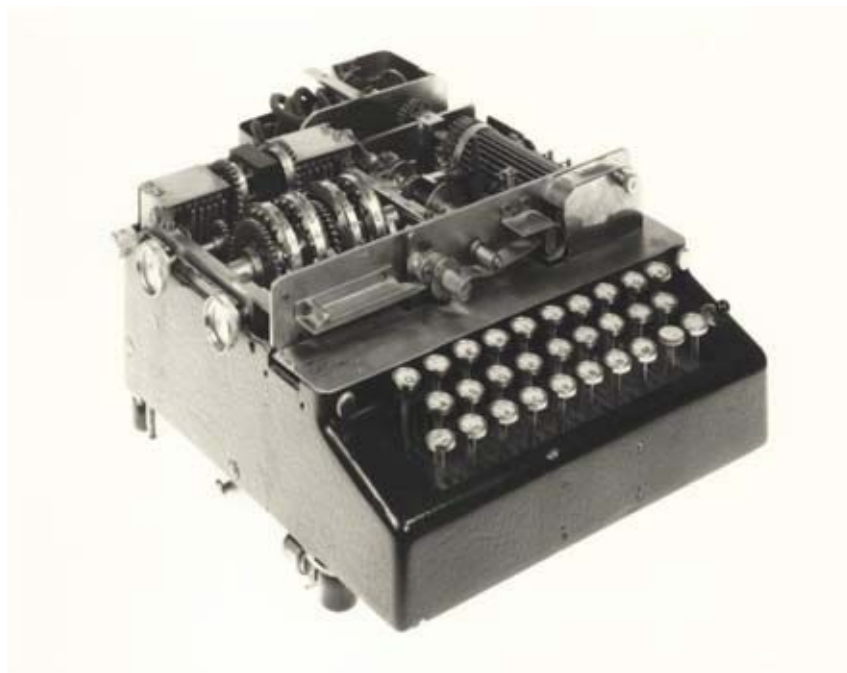
Abb. 5–8 Die B-211 von Hagelin war etwa zur gleichen Zeit wie die Enigma im Einsatz. Sie erwies sich als unsicher, was sich jedoch bei den Nachfolgemodellen ändern sollte.
