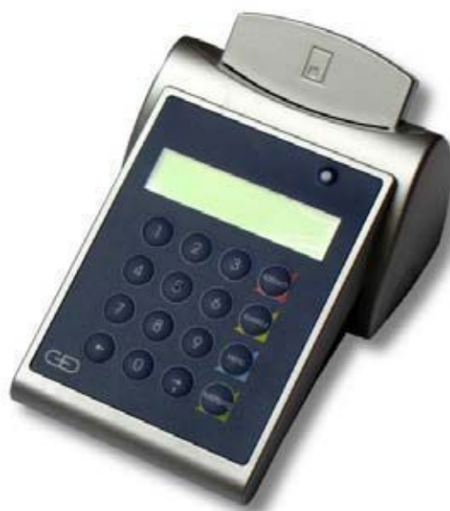
Abb. 28–2 Ein Karten-Terminal mit eingebauter Tastatur erschwert Malware-Angriffe.
