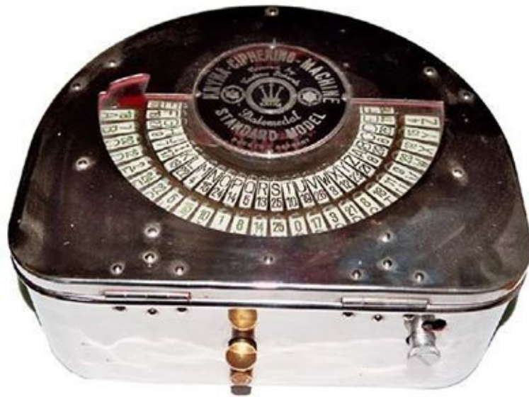
Abb. 5-7 Die in Deutschland entwickelte Kryha-Maschine erwies sich als unsicher.
