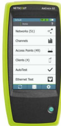
Das 5-Zoll-Display des AirCheck G2 von Netscout stellt die Ergebnisse des WLAN-Tests übersichtlicher dar als sein Vorgänger, der nur ein 2,8-Zoll-LCD mitbrachte.
