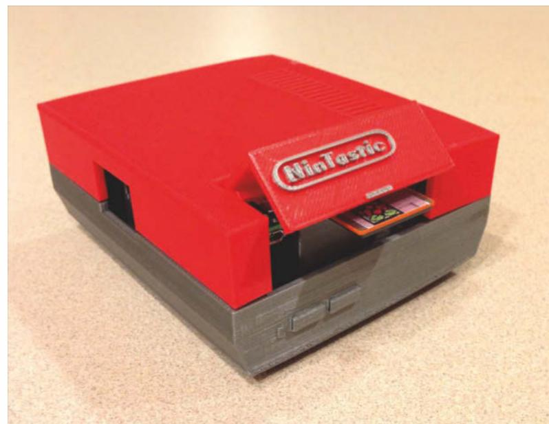
**Charmant:** Wer Zugriff auf einen 3D-Drucker hat, kann sich mit einer kostenlosen Thingiverse-Vorlage ein Raspberry-Pi-Gehäuse in Form einer NES-Konsole ausdrucken.
