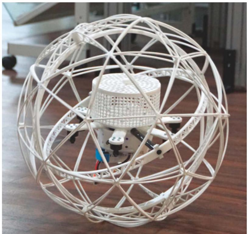
Die vom Fraunhofer IML entwickelte Transportdrohne „BinGo“ rollt, wenn sie kann, und fliegt nur, wenn sie muss.
