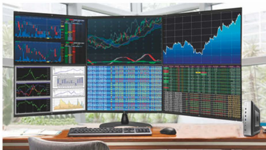
Nativ unterstützt der HP t730 bis zu vier Monitore bei einer 4K-Auflösung. Mit einer optional verfügbaren AMD-FirePro-Grafikkarte können sogar bis zu sechs Monitore gleichzeitig genutzt werden. Anwender profitieren bei einer Auflösung von 3840 x 2160 Bildpunkten von einer atemberaubenden Bildschärfe und hoher Bildgenauigkeit.
