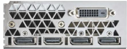
Die GeForce GTX 1080 kann vier Displays gleichzeitig ansteuern, und zwar über DVI, DisplayPort 1.4 und HDMI 2.0b.
