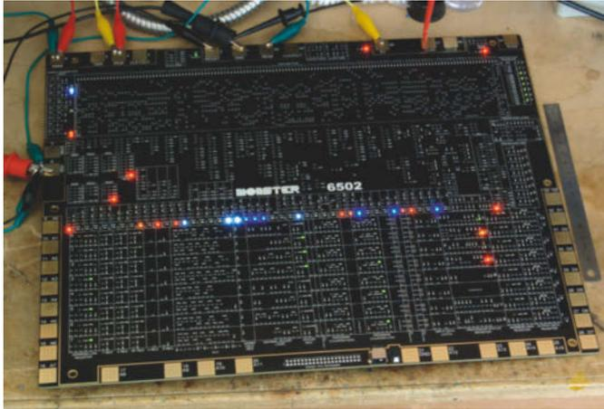
Diskreter Nachbau eines 6502-Prozessors:
