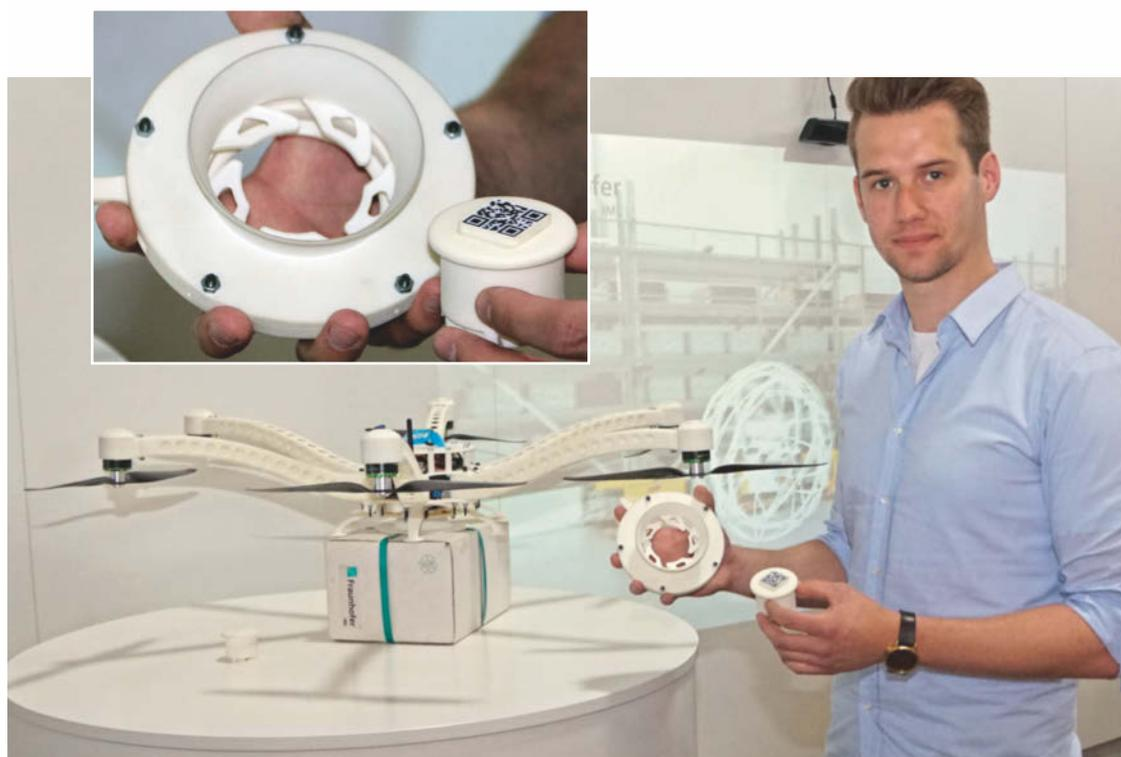
Philip Wrycza, Projektleiter im Team AutoID-Technologien, präsentiert das zum Patent angemeldete Haltesystem des IML. Der mit dem Frachtgut verbundene Adapter wird von einem Verschluss gehalten, der wie eine Fotoblende arbeitet.
