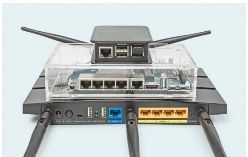
TP-Link und Banana R1 enthalten einen Switch mit vier Ports. Ein Raspi bedient nur drahtlose Kundschaft und braucht dafür obendrein einen von OpenWRT unterstützten USB-WLAN-Adapter.
