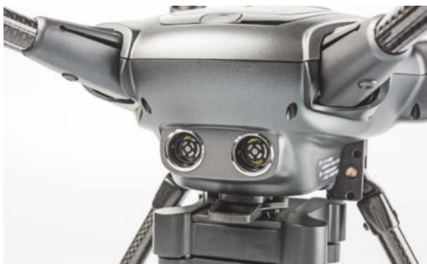
An der Front befinden sich die beiden Ultraschallsensoren des Anti-Kollisionssystems.
