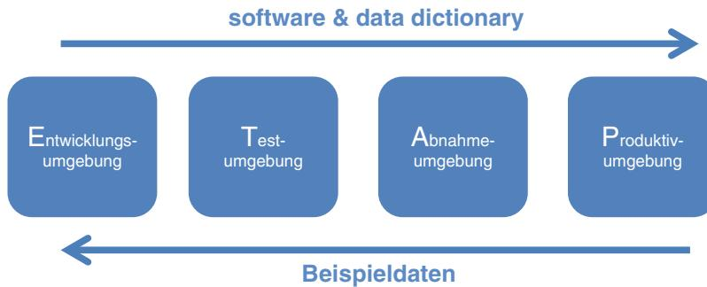
Die Produktivumgebung ist das System (Server + Datenbank), in dem die Anwendung in der Praxis eingesetzt wird. Die anderen Umgebungen in der DTAP-Street sind mehr oder weniger Kopien dieser Produktivumgebung.
