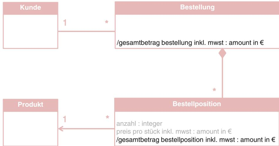
In diesem Beispiel wird der Gesamtbetrag der Bestellung sowie der Gesamtbetrag der Bestellposition automatisch berechnet.
