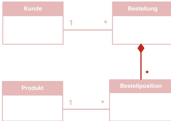
Im Beispiel sorgt die Komposition bei der Bestellung dafür, dass beim Löschen der Bestellung automatisch und ohne Rückfrage alle dazugehörigen Bestellpositionen ebenfalls gelöscht werden.
