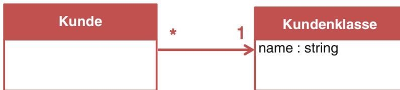
Zu einer Referenzklasse wird über eine Assoziation zu einer anderen Klasse referenziert. Objekte einer Referenzklasse werden häufig durch Anwendungsadministratoren gepflegt.
