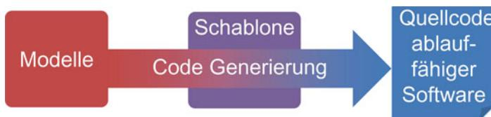
Die **Schablonen (templates)** werden, oft unter Verwendung von open-source-Tools, so erstellt, dass der generierte Code in die vom Auftraggeber vorgesehene Architektur passt.
