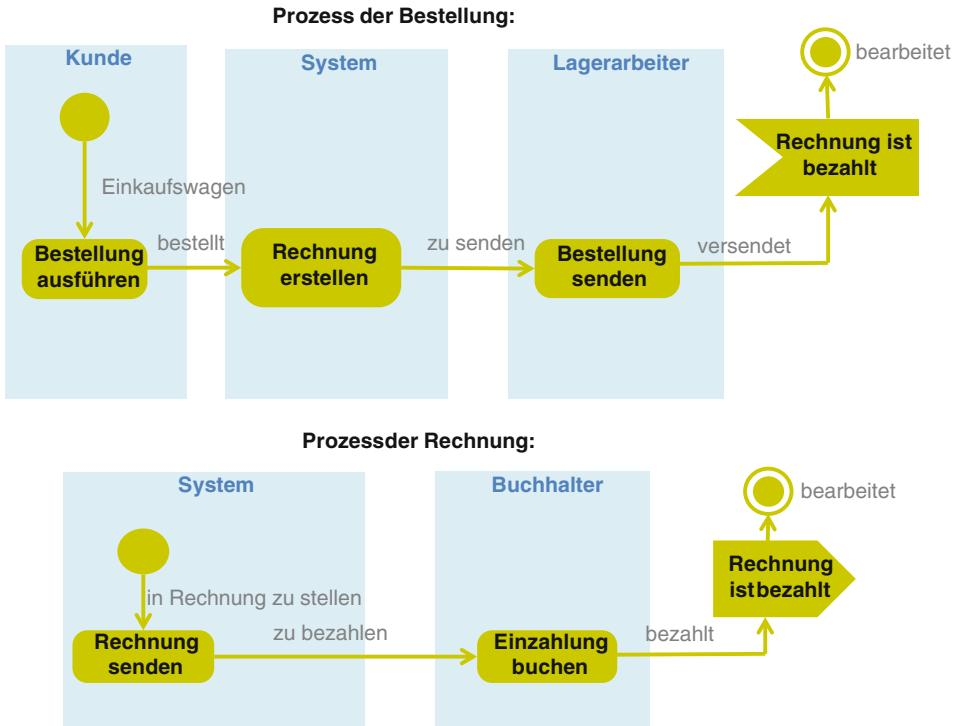
Der Prozess einer Rechnung sendet das Signal „Rechnung ist bezahlt“ aus. Dieses Signal wird durch den Bestellprozess akzeptiert, wodurch die Bestellung in den Zustand „bearbeitet“ übergeht.
