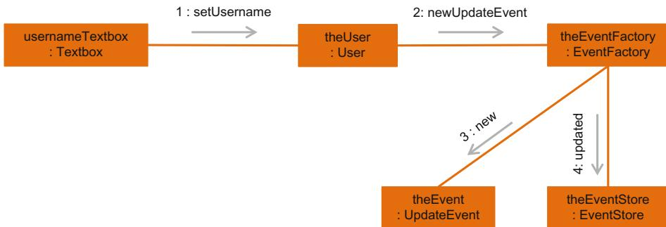
Dieses Kommunikationsdiagramm zeigt die gleichen Methodenaufrufe wie im vorangegangen Beispiel des Sequenzdiagramm.
