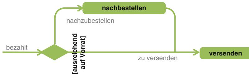
Wenn hier die Ware die Bedingung „ausreichend auf Vorrat“ erfüllt, dann verändert sich der Zustand automatisch in „zu versenden“. Unter dem Prozessdiagramm oder an einer anderen Stelle innerhalb des funktionalen Entwurfs muss genau beschrieben werden, was die Bedingung „ausreichend auf Vorrat“ beinhaltet (also wie die automatisch ablaufende Entscheidung kontrolliert, ob ausreichend Vorrat vorhanden ist).
