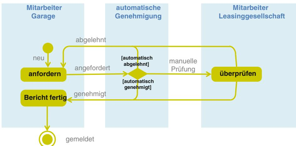
Wenn an dem Ausgang eines Entscheidungsknotens eine **Bedingung** (**guard**) steht, dann steht diese Bedingung in eckigen Klammern [ ].
