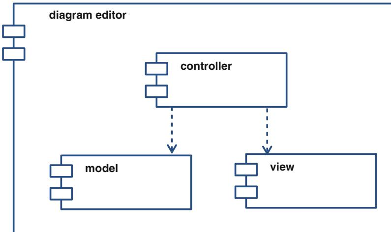
In diesem Beispiel umfasst die Komponente **diagram editor** die Komponenten **controller**, **model** und **view**.
