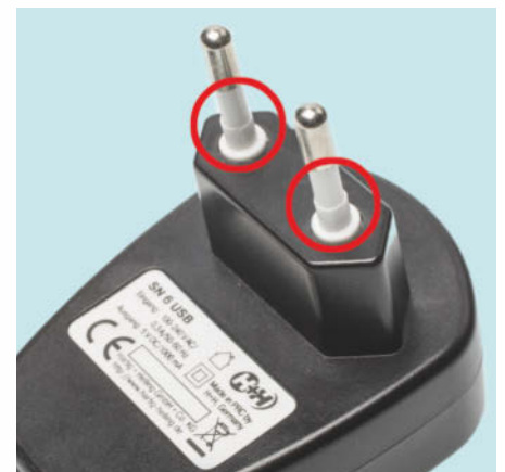
Die Stifte von Eurosteckern müssen ungefähr bis zur Hälfte isoliert sein.
