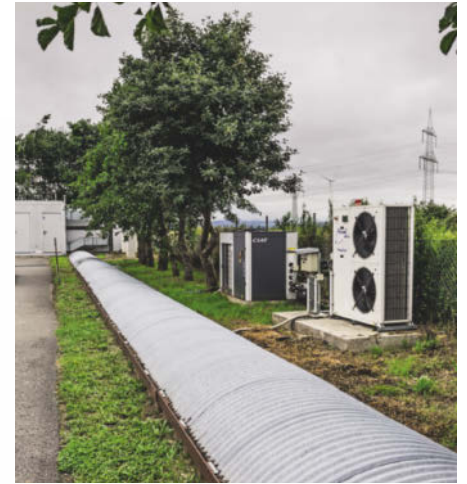
Unter diesem schlichten Wellblech liegt ein 600 Meter langes Edelstahlrohr: einer der beiden Arme von GEO600.
