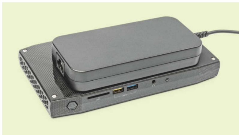
Mini-PCs wie der NUC6i7KYK bringen immer mehr Leistung in immer kleineren Gehäusen unter. Das führt dazu, dass das zugehörige Netzteil manchmal fast halb so groß ist wie der Rechner.
