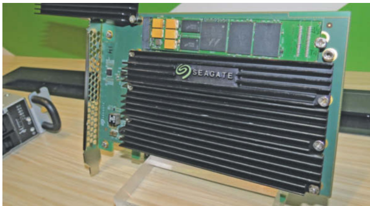
Bis zu 10 GByte/s soll Seagates PCIe-SSD Nyro XP7200 schaffen. Dazu muss man allerdings die vier M.2-SSDs per Software-RAID zusammenschalten.
