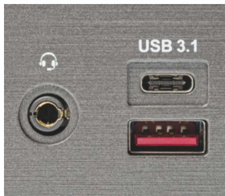
USB-3.1-Geräte lassen sich am Gigabyte Brix GB-BSCEHA-3955 sowohl über eine Typ-A- als auch über eine Typ-C-Buchse anschließen.
