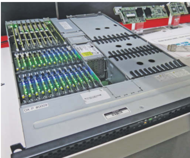
Toshiba bringt in seinem Flashmatrix-Server auf zwei Höheneinheiten 12 Linux-Server und 24 Speichereinschübe unter.
