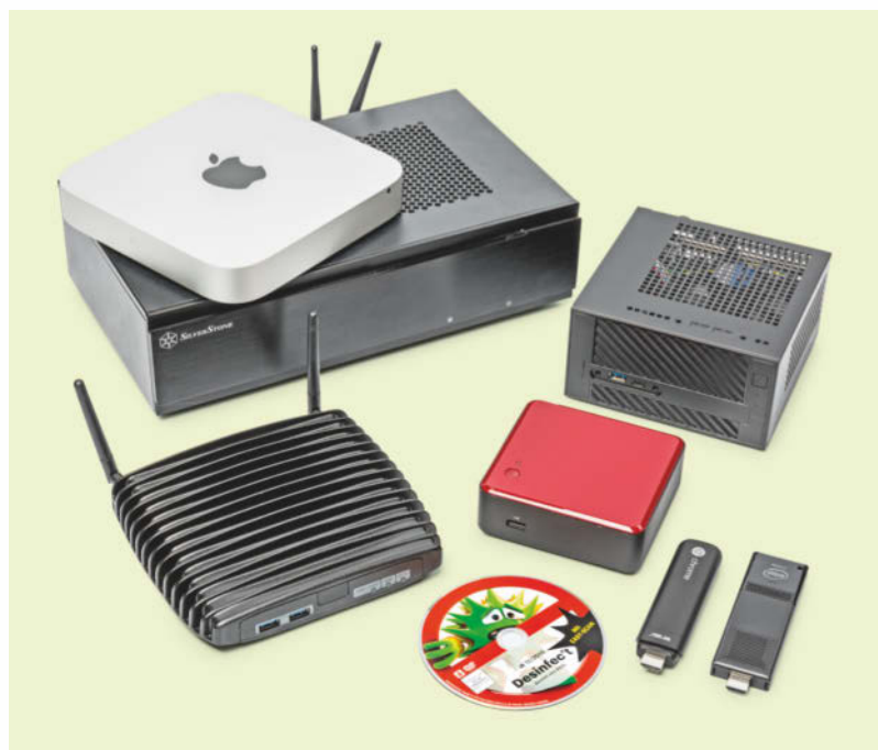
Die Neuen und der Urahn: Der silberne Mac mini, der oben auf dem Mini-ITX-Gehäuse liegt, wirkt im Vergleich zu aktuellen Mini-PCs wuchtig. Spezial-Rechner mit Kühlrippen kommen ohne Lüfter aus.
