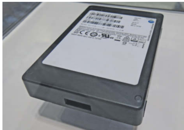
Die größte SSD im 2,5-Zoll-Gehäuse präsentierte einmal wieder Samsung: 32 TByte Flash mit 15 Millimeter Höhe.
