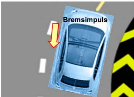
Bild 13.6 Wirkungsweise von ESP: Korrektur des Übersteuerns oder Untersteuerns durch gezielte Bremsenriffe
