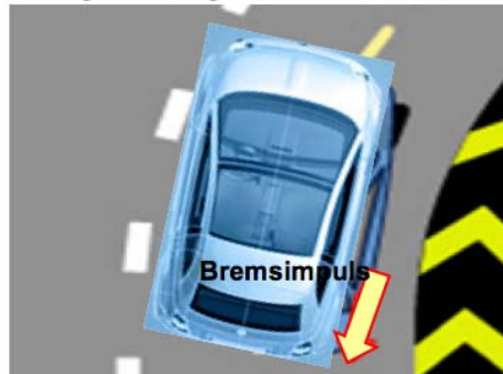
Bild 13.6 Wirkungsweise von ESP: Korrektur des Übersteuerns oder Untersteuerns durch gezielte Bremsenriffe
