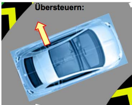
Übersteuern: ESP-Korrektur des Übersteuerns: Bremsimpuls am kurvenäußeren Vorderrad erzeugt ein korrigierendes Giermoment
