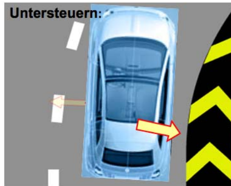
Untersteuern: ESP-Korrektur des Untersteuerns: Bremsimpuls am kurveninneren Hinterrad erzeugt ein korrigierendes Giermoment
