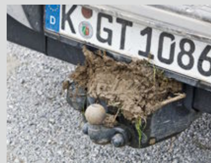
Exponiert: Die Hängerkupplung hatte viel Bodenkontakt, zwei Steckdosen überlebten nicht.
