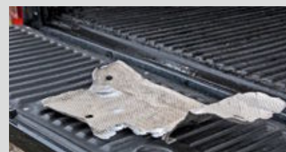
Das Hitzeschutzblech des Mitteltopfs löste sich auf der Heimfahrt aus Bulgarien.
