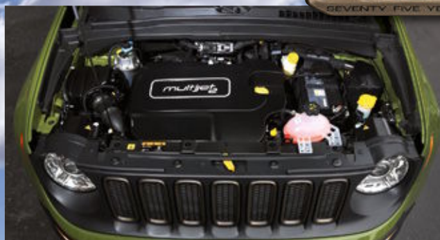
Starker Diesel: Das 2.0-MultiJet-Aggregat bringt es auf 140 PS.
