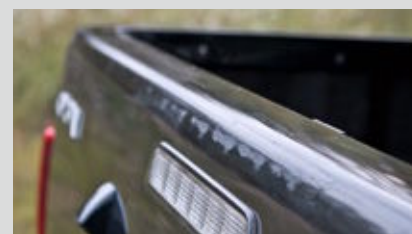
Die Gummipuffer der Laderaumabdeckung nutzten sich durch die Belastung ab. Dadurch zerkratze das Riffelblech die Ladeklappe.
