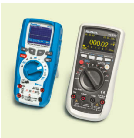
Das PeakTech 3440 stellt dank Grafikdisplays sogar Messkurven dar und versendet Messdaten per Bluetooth. Das Voltcraft VC890 ist mit seinem OLED-Display sparsamer, Daten gibt es über eine galvanisch getrennte optische Schnittstelle aus.
