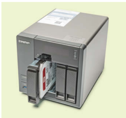
Typisch für bessere NAS: Schnellwechselrahmen für Festplatten und ein kleines Status-Display mit Bedientasten.
