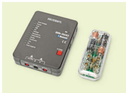
Die Datenlogger Voltcraft BB-500 und Mooshimeter übermitteln aktuelle Messwerte per Bluetooth an eine App.
