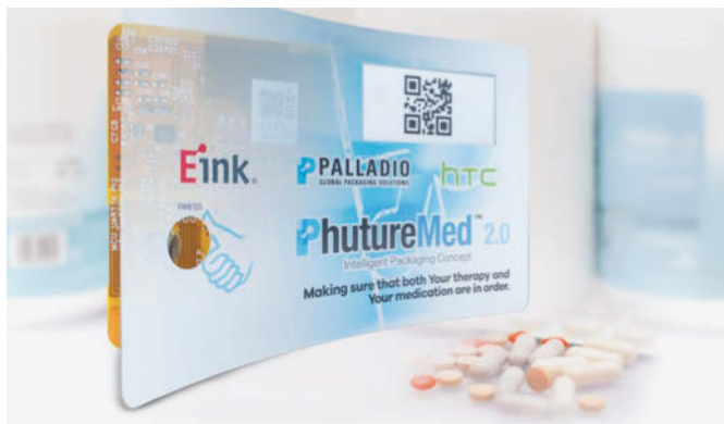
Ein bistabiles E-Ink-Display auf Pillenboxen soll Patienten die regelmäßige Tabletteneinnahme erleichtern.
