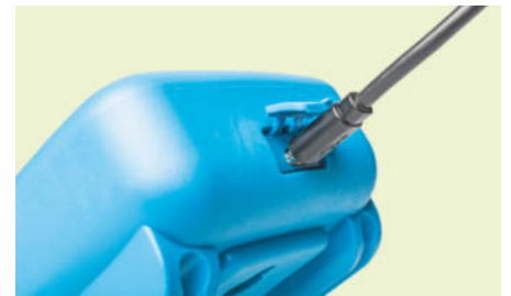
Einige Multimeter haben für Daten einen galvanisch getrennten USB-Anschluss, ...
