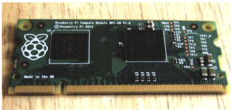
» Das Compute Module ist eine kleine Platine der Größe eines SODIMMs, die entwickelt wurde, sich in industrielle Umgebungen zu integrieren.
