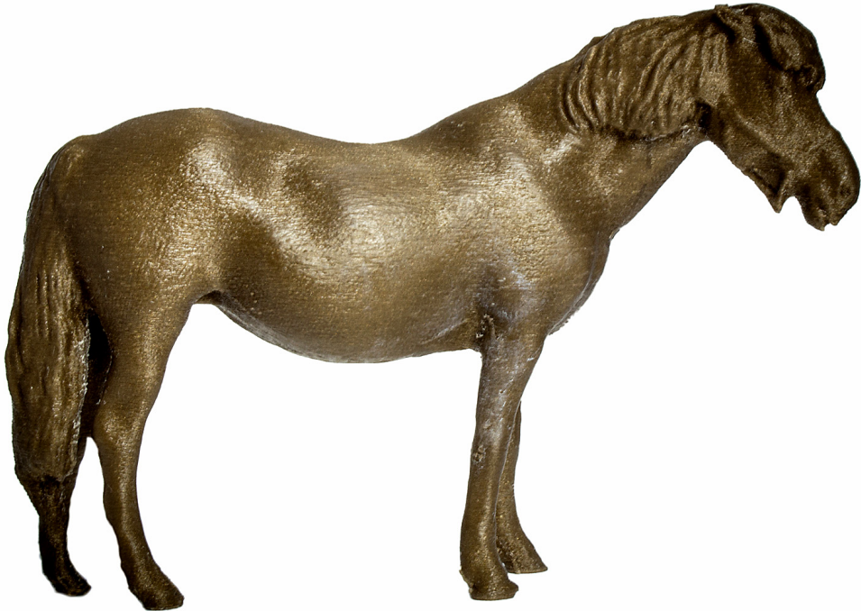
Abbildung 7.15 Das Pferd nach dem Polieren mit THF. Die Unterschiede sind nicht gewaltig, aber vorhanden.
