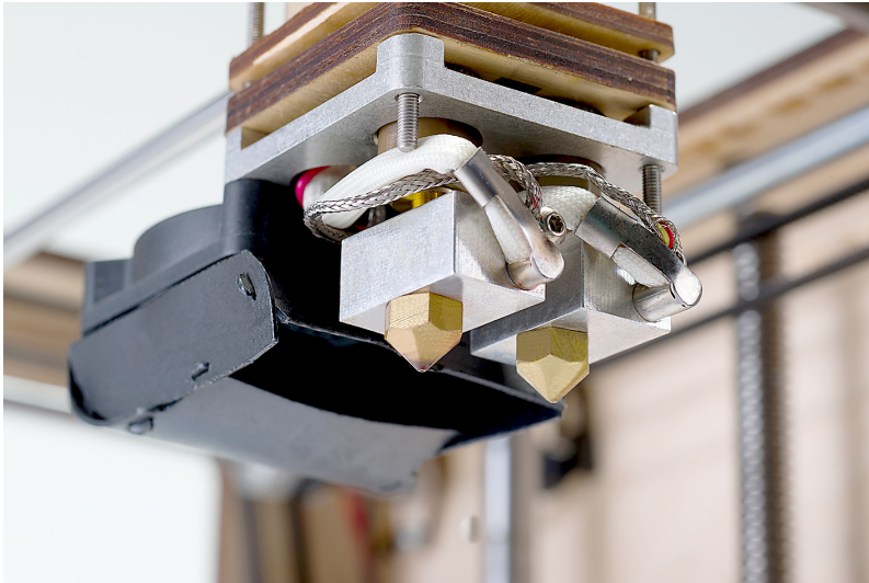
Abbildung 4.13 Ein Dual Extruder mit zwei unabhängigen Druckdüsen (Quelle: Ultimaker.com)
