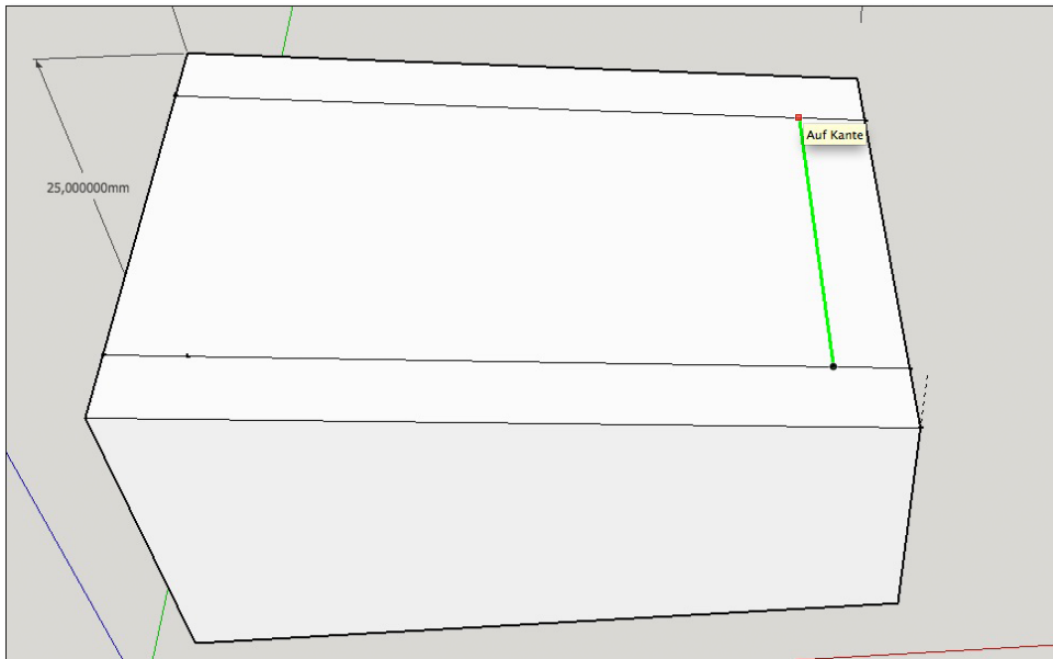
Abbildung 6.67 Die Linie wird auf der grünen Achse zur oberen Hilfslinie gezogen und hat so den gleichen Abstand von 5 mm.
