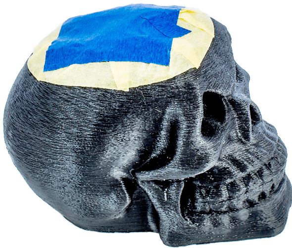
Abbildung 7.30 Um nicht für die größeren Flächen das teurere Masking Tape zu verschwenden, benutzen Sie einfach das Blue Tape.
