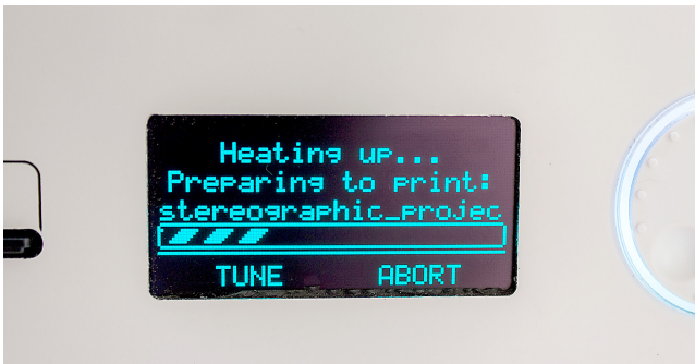
Abbildung 3.38 Aufwärmphase des Druckkopfes und Heizbetts
