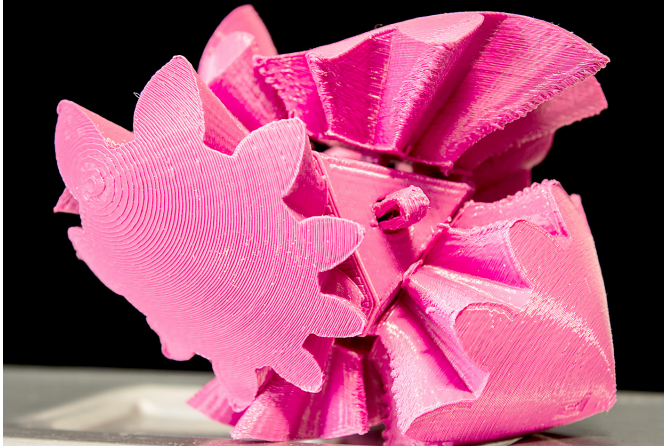
Abbildung 4.18 Bei einer Auflösung von nur noch 0,1 mm sieht man die Schichten kaum noch mit bloßem Auge.
