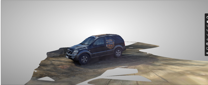
Abbildung 5.10 3D-Modell, mit Hilfe von Autodesk ReCap 360 erstellt
