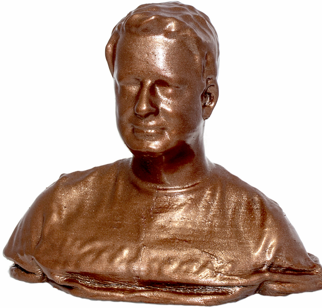
Abbildung 7.10 Eine zu kleine Plattform hat das Objekt am Rand zerfließen lassen.
