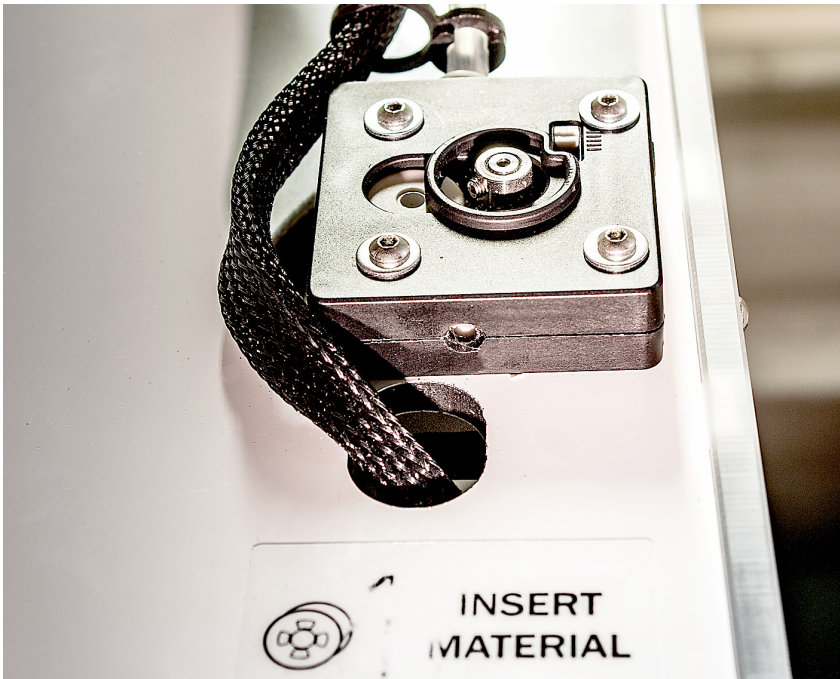
Abbildung 3.5 Öffnung für die Filamentzuführung in den Material Feeder
