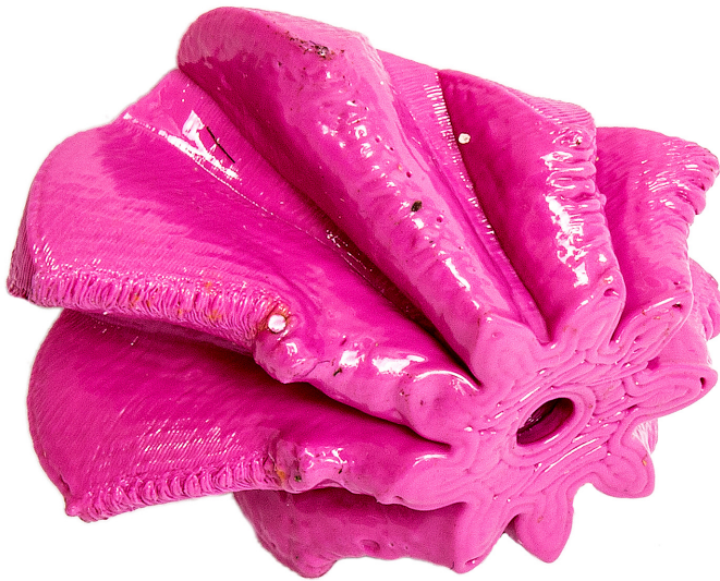
Abbildung 7.16 Ein PLA-Objekt, mit dem Heißluftfön bearbeitet. Es glänzt zwar, ist aber durch die extreme Hitze verformt.
