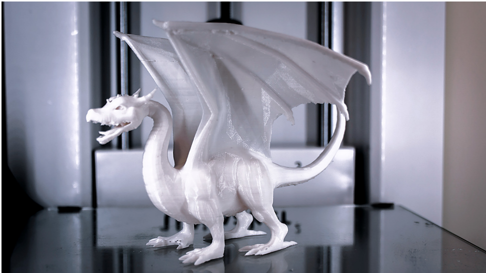
Abbildung 7.2 Der Drache nach dem Entgraten und Feilen
