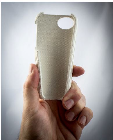
Abbildung 4.30 Die Biegsamkeit des flexiblen Filaments ist schon eindrucksvoll, im Beispiel die Handyschale eines iPhone 5.
