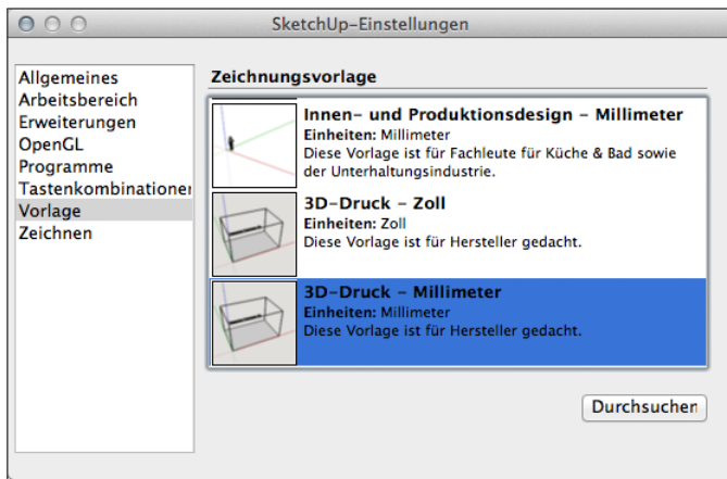
Abbildung 6.17 Eine dauerhafte Vorlage für die spätere Arbeit auswählen, in diesem Fall die »3D-Druck«-Vorlage
