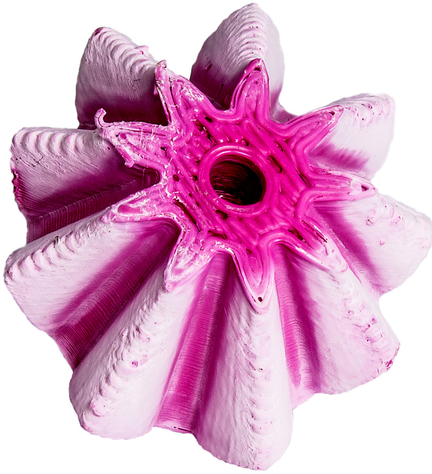
Abbildung 7.12 Außer der weißen Schicht hat das PLA-Objekt nicht auf das Aceton-Bad reagiert. Eine Glättung ist in keinsten Weise zu erkennen.
