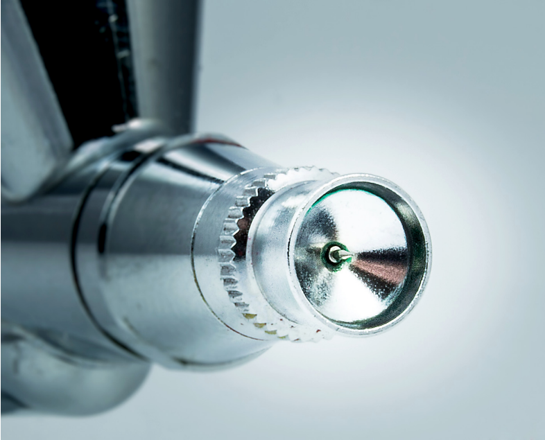
Abbildung 7.34 Die Düsenöffnung bei einer Airbrush-Pistole kann bis zu 0,15 mm klein sein.
