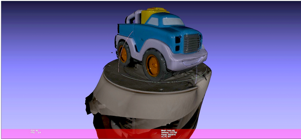
Abbildung 5.8 Der Rohscan eines Spielzeugautos
