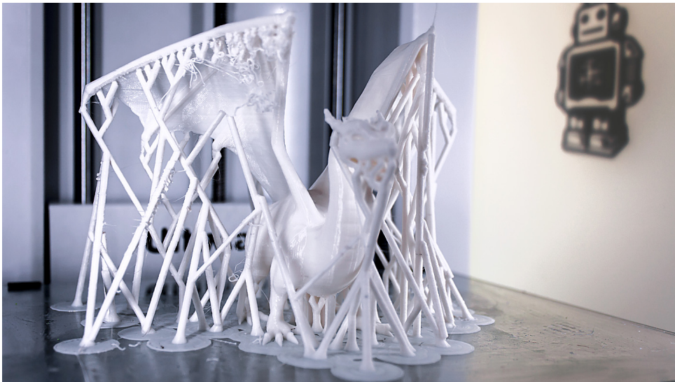
Abbildung 7.1 Eine hohe Zahl an Stützelementen erfordert auch eine entsprechende Nachbearbeitung.
