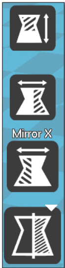
Abbildung 3.25 Spiegeln Sie das Objekt mit der Mirror-Funktion auf jede Achse.
