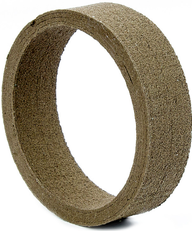
Abbildung 7.4 Ein mit BronzeFill gedruckter Ring – vor dem Schleifvorgang
