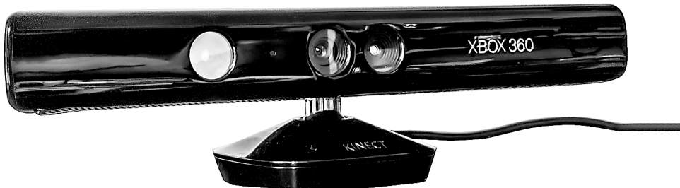
Abbildung 5.23 Der Kinect-Sensor von Microsoft – die Tiefensensoren befinden sich jeweils außen, in der Mitte befindet sich die Farbkamera.
