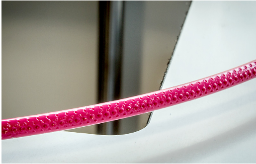
Abbildung 4.9 Die Einkerbungen im Filament stammen vom Drive Bolt.
