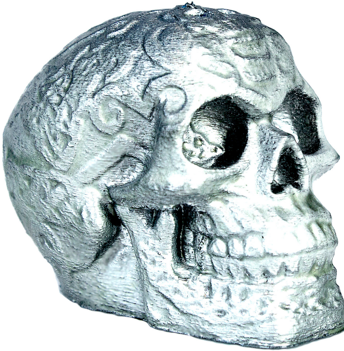
Abbildung 7.19 Der Celtic Skull – ein Großteil der Schichten wurde durch den Sprühlack überdeckt, und die Details sind erhalten geblieben. Die Objektgröße beträgt hier übrigens nur ca. 3 cm in der Höhe(!).
