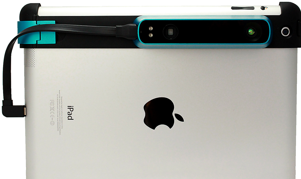
Abbildung 5.39 Die interne Kamera vom iPad ist für die Software zwingend notwendig, um ein 3D-Modell zu erzeugen. (Quelle: Occipital.com)
