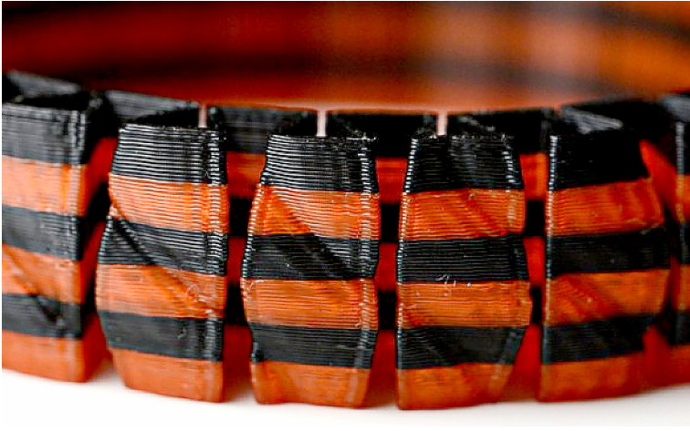
Abbildung 4.22 Optimales Druckergebnis mit zwei Extrudern (Quelle: iGo3D.de)
