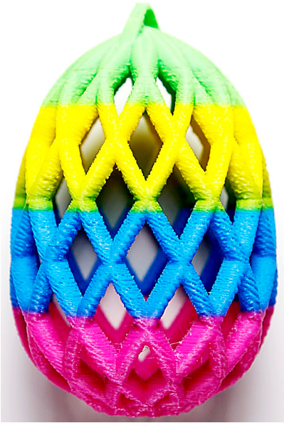
Abbildung 4.20 Mehrere Farben in einem Objekt – dieses Ei wurde mit Hilfe farbiger Stickfilamente hergestellt. (Quelle: www.stickfilament.com )
