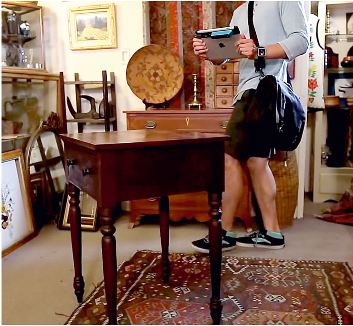
Abbildung 5.4 Objekterfassung mit Hilfe des mobilen 3D-Scanners (Quelle: Produktvideo Occipital.com)
