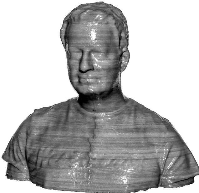
Abbildung 7.9 Ein mit Aceton übergossenes Objekt, der Glanz ist deutlich zu sehen.
