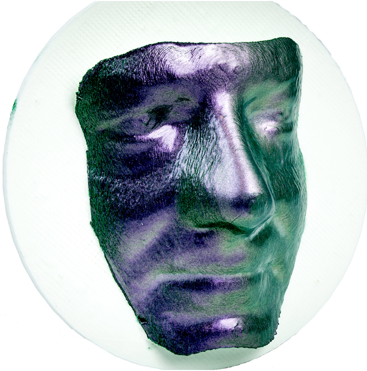
Abbildung 7.20 Der Flip-Flop-Lack schimmert je nach Betrachtungswinkel in einer anderen Farbe.
