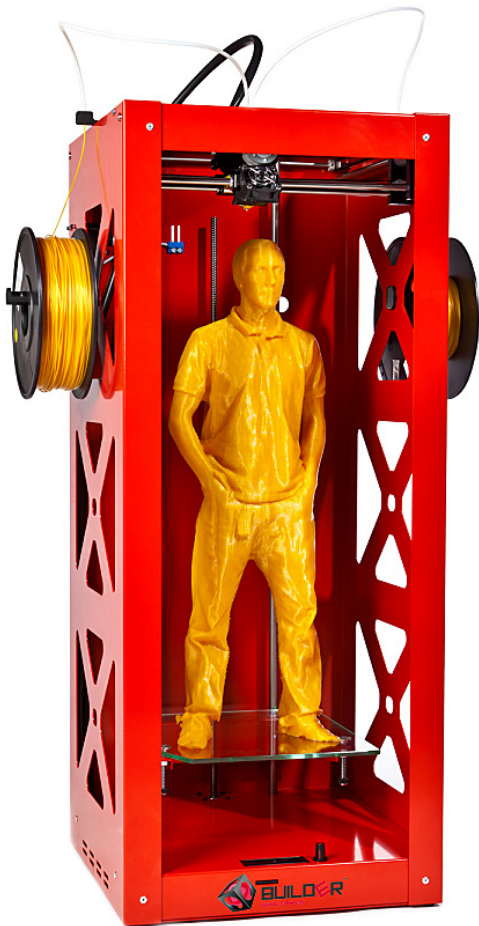
Abbildung 2.18 Der Big Builder mit einer maximalen Druckhöhe von 66,5 cm (Quelle: iGo3D.com)
