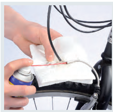
Bei Cantilever- und V-Brakes die Stelle schmieren, wo das Kabel aus dem Bowdenzug austritt.
