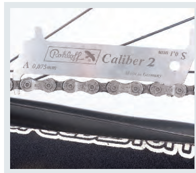
Leichter Verschleiß der Kette mit Verschleißanzeige von Rohloff
