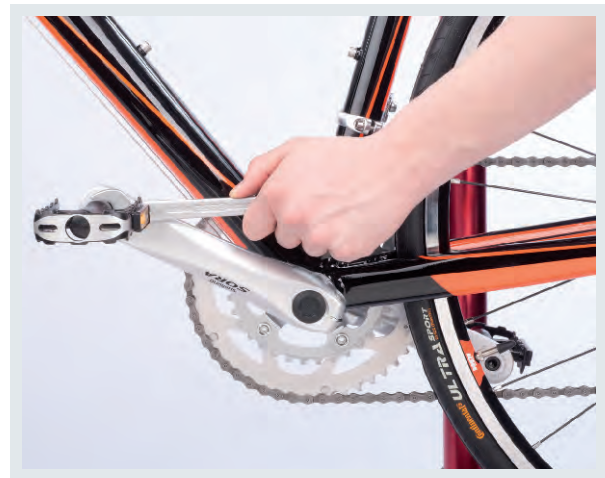
Linke Pedale abschrauben: gegen den Uhrzeigersinn
