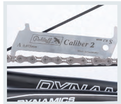
Neuwertige Kette mit Verschleißanzeige von Rohloff
