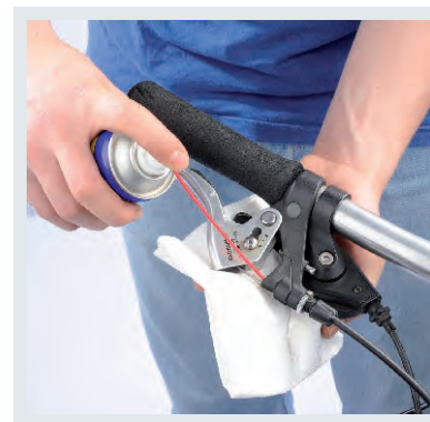
Und nicht vergessen: auch das Kabel am Bremshebel und die Gelenke ölen.
