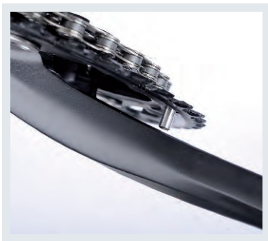
Kettennietfang am größten Kettenblatt
