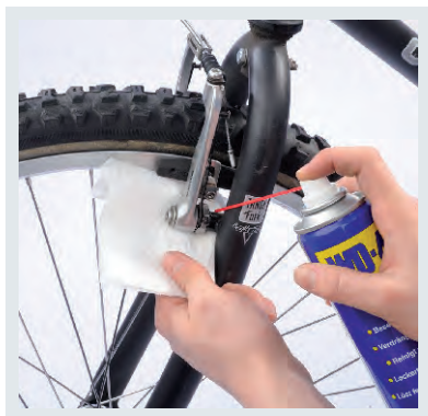
Bei Cantilever- und V-Brakes sind vor allem die Drehpunkte und das Querkabel zu schmieren.
