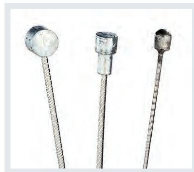
Quer- oder Tonnennippel und Birnennippel bei Bremszügen (links) sowie Nippel bei einem Schaltzug (rechts)
