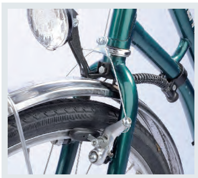
Ältere Cantilever-Bremse mit Querzug und Klemmhaken
