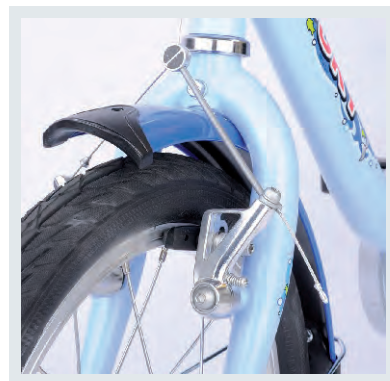
Neuere Cantilever-Bremse mit Verbindungskabel zum linken Bremsarm
