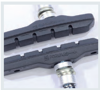
Anzeige der Laufrichtung auf Bremsschuhen beachten.
