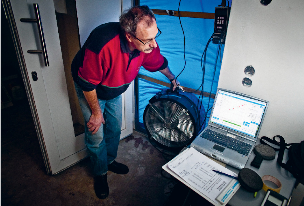
Folientür mit Gebläse zur Durchführung des Blower-Door-Tests. Die Messung deckt Dichtheitsmängel in der Gebäudehülle auf, so werden handwerkliche Fehler entlarvt, bevor sie über erhöhten Energiebedarf im Geldbeutel spürbar werden.
