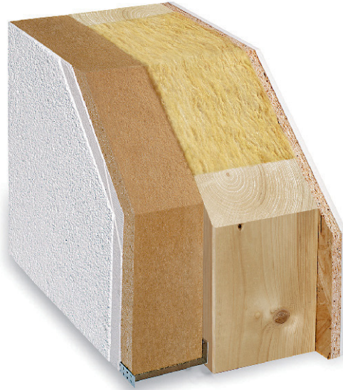
Beispielhafter Aufbau eines Wandelements im Holzfertigbau. Gut erkennbar ist hier der recht komplexe Aufbau (von links nach rechts) aus Putz, MDF-Platte, Massivholzlatte mit Dämmstoff und Sperrholz.
