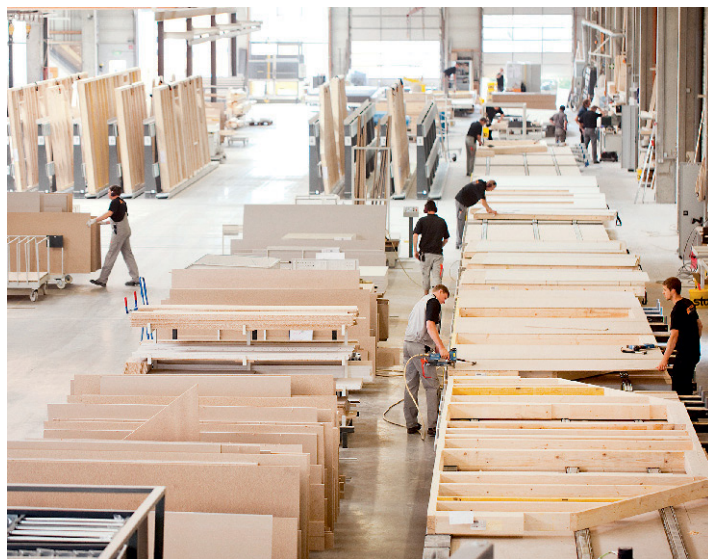
Der Aufbau von Wandelementen in einer Fertigungshalle
