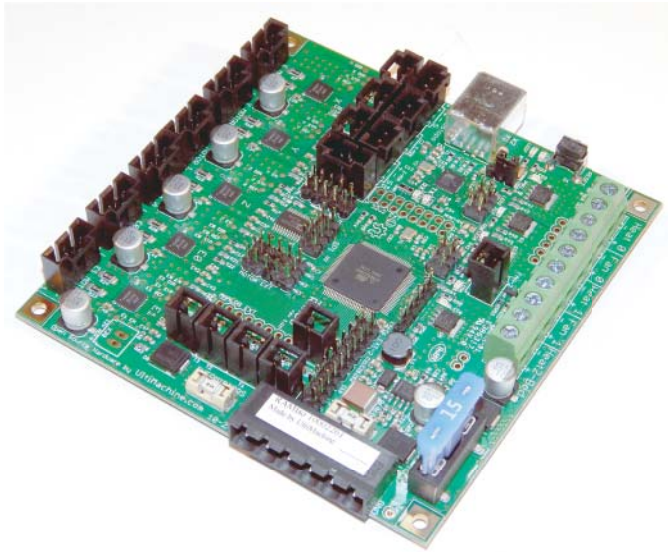
Abbildung 13.2: RAMBo kombiniert Arduino MEGA und ein RAMPS-Shield zu einem kompakten Board.
