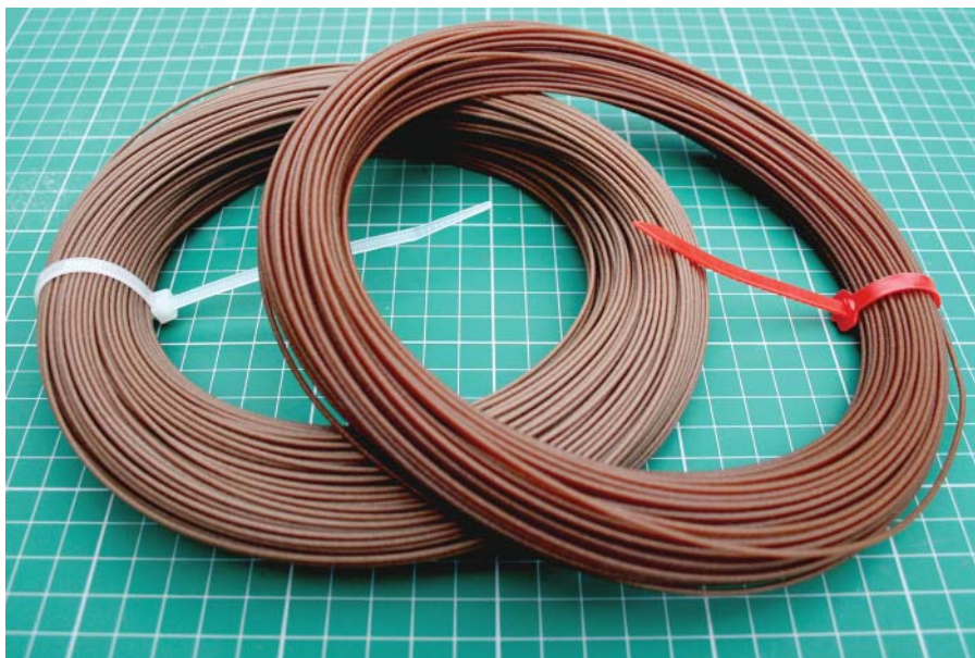
Abbildung 11.12: LayWood kann unter Anwendung unterschiedlicher Temperaturen unterschiedlich gefärbt werden und sogar Maserungseffekte erhalten.
