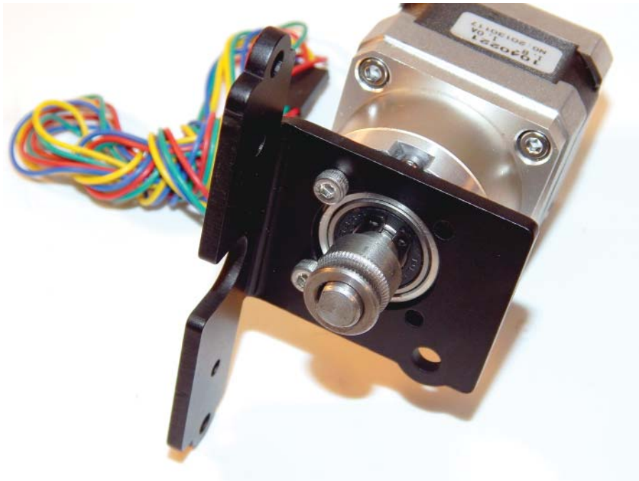
Abbildung 14.3: Ein professionelles Getriebe am Schrittmotor verbessert die Leistung (selbst bei einem kleineren Motor).
