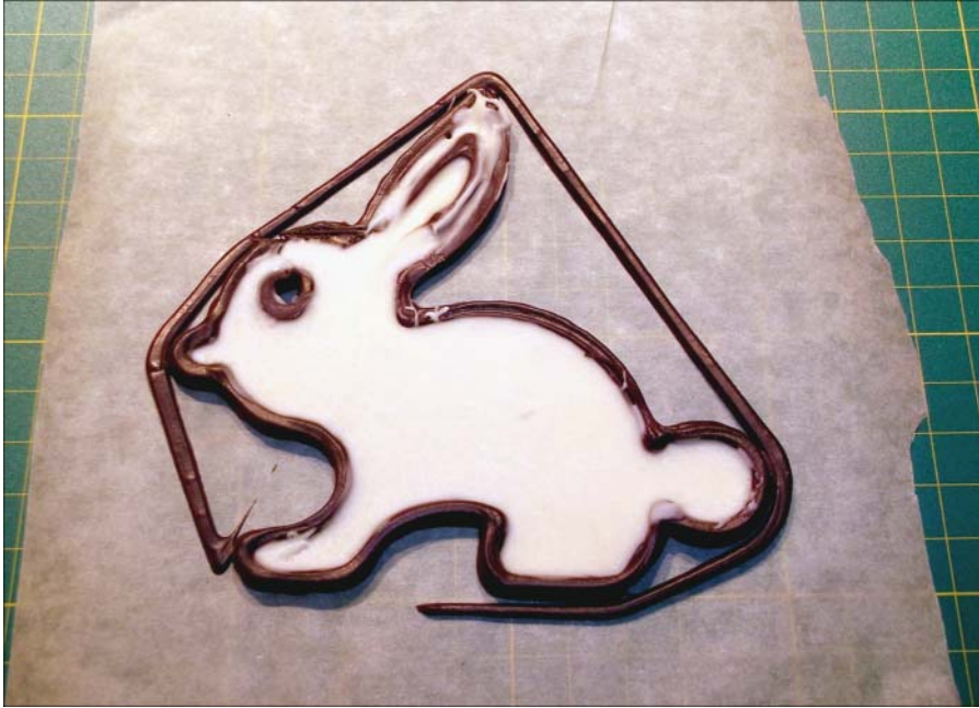
Abbildung 4.5: 3D-gedruckter Schwarz-Weiß-Schokohase, hergestellt mit einem RepRap-3D-Drucker und dem Universal Pasten-Extruder von Richard
