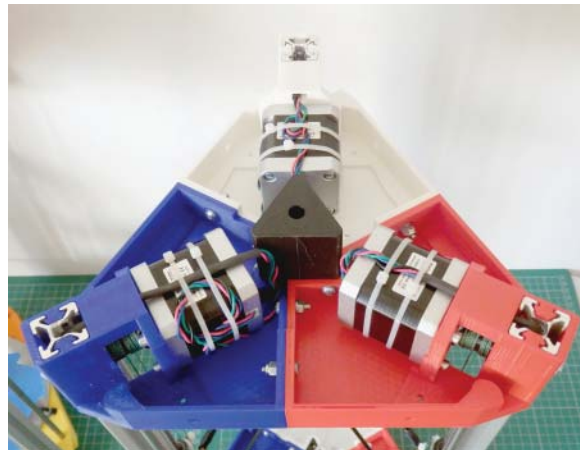
Abbildung 12.14: Die drei Motoren, die den Drucker antreiben, sind ebenfalls an den 3D-gedruckten Teilen angebracht.
