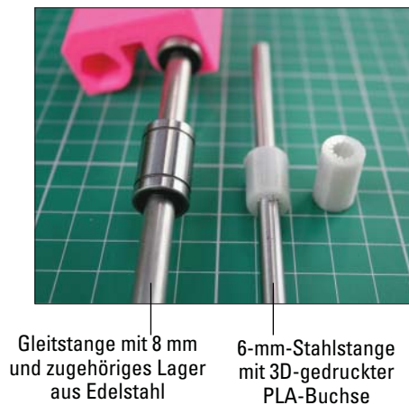
Abbildung 12.5: Die Stangen und Lager in einem 3D-Drucker ermöglichen dem Wagen oder der Achse, reibungslos nach oben oder unten zu gleiten.
