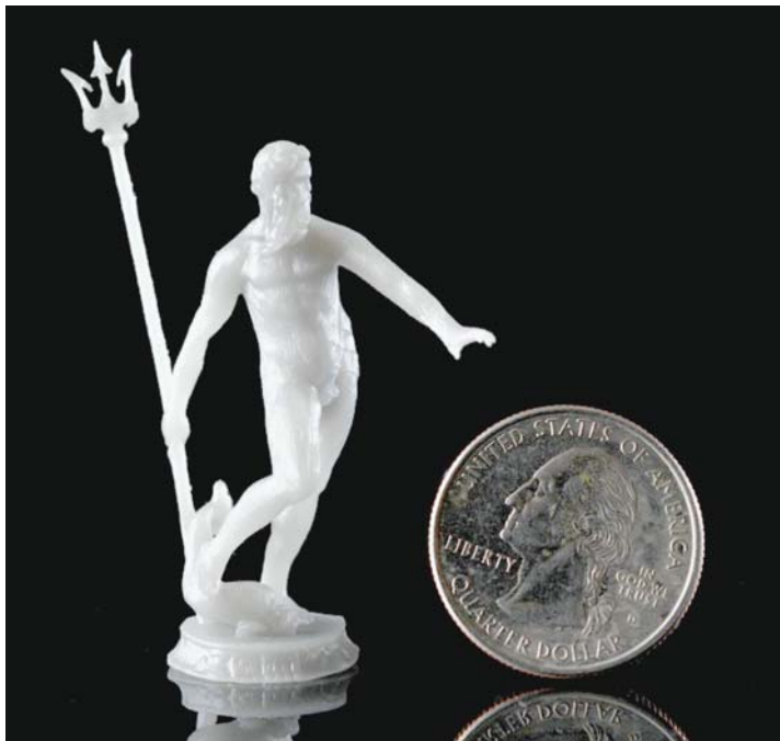
Abbildung 2.4: Beispiel für eine mit dem Drucker FormOne gedruckte Stereolithografie
