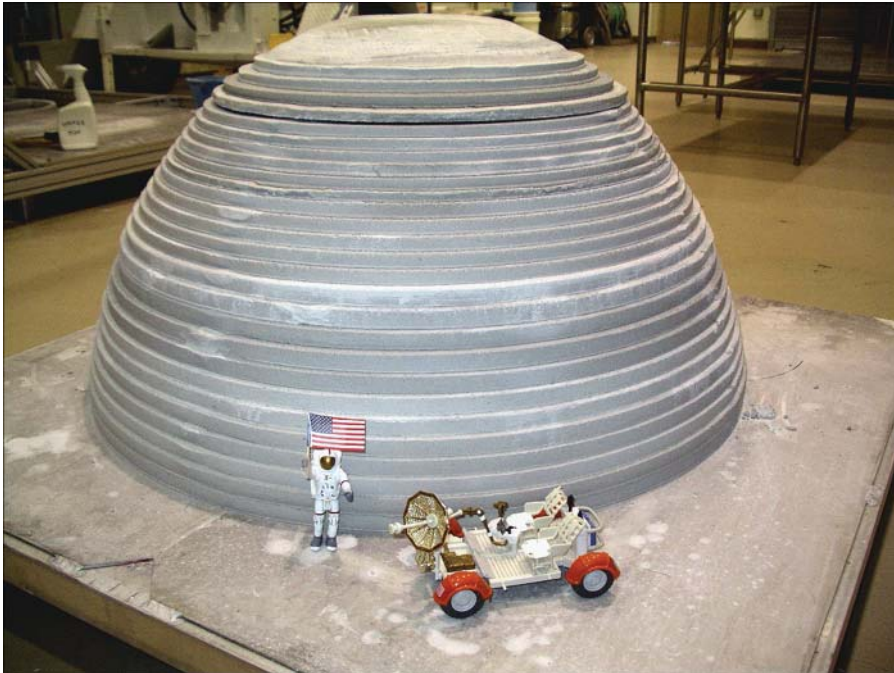
Abbildung 3.16: Ein Modell eines Wohnhauses auf dem Mond, gedruckt aus Beton (Bild mit freundlicher Genehmigung von Contour Crafting)
