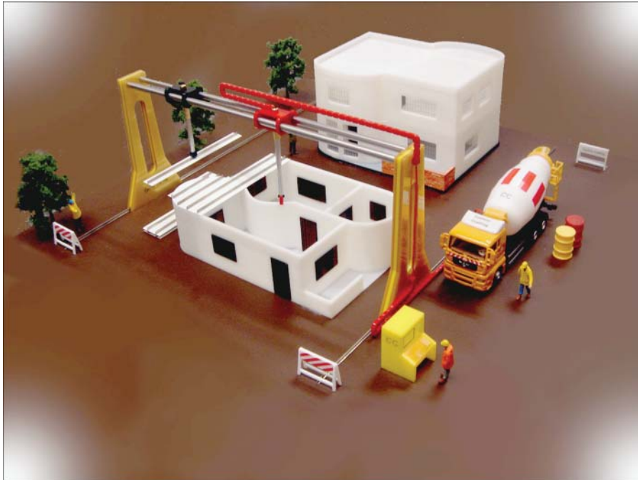
Abbildung 3.7: Ein 3D-Drucker für Häuser (Bild mit freundlicher Genehmigung von Contour Crafting)
