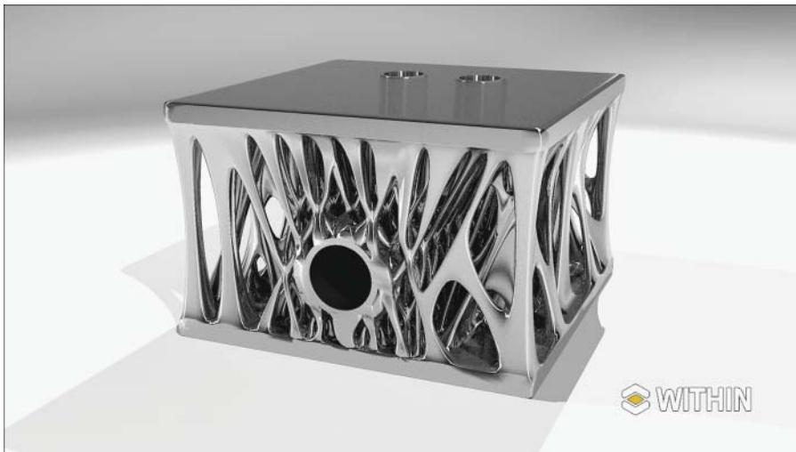
Abbildung 3.3: Leichtes Einlasskühler-System für Rennautos, erstellt mit einer komplexen Anordnung von Hohlräumen im Inneren, um Gewicht zu sparen (Bild mit freundlicher Genehmigung von WithinLab)
