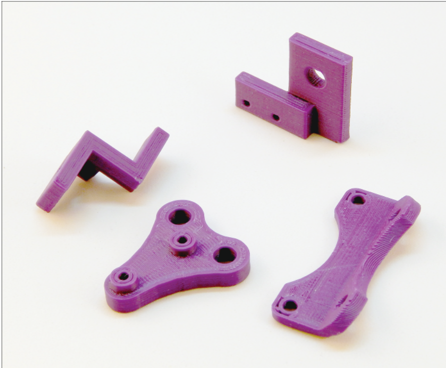
Abbildung 5.1: Vier Klammern für die Elektronik, die für den Zusammenbau des MendelMax 2.0 RepRap-3D-Druckers benötigt werden
