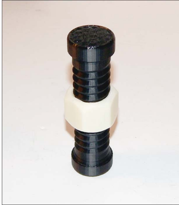
Abbildung 4.2: Ein Spielzeug, ausgedruckt auf einem 3D-Drucker, mit gedruckter Mutter, die auf eine Schraube mit zwei Köpfen aufgebracht wurde, indem der Druck der Schraube unterbrochen wurde, um die Mutter in einer anderen Farbe zu drucken
