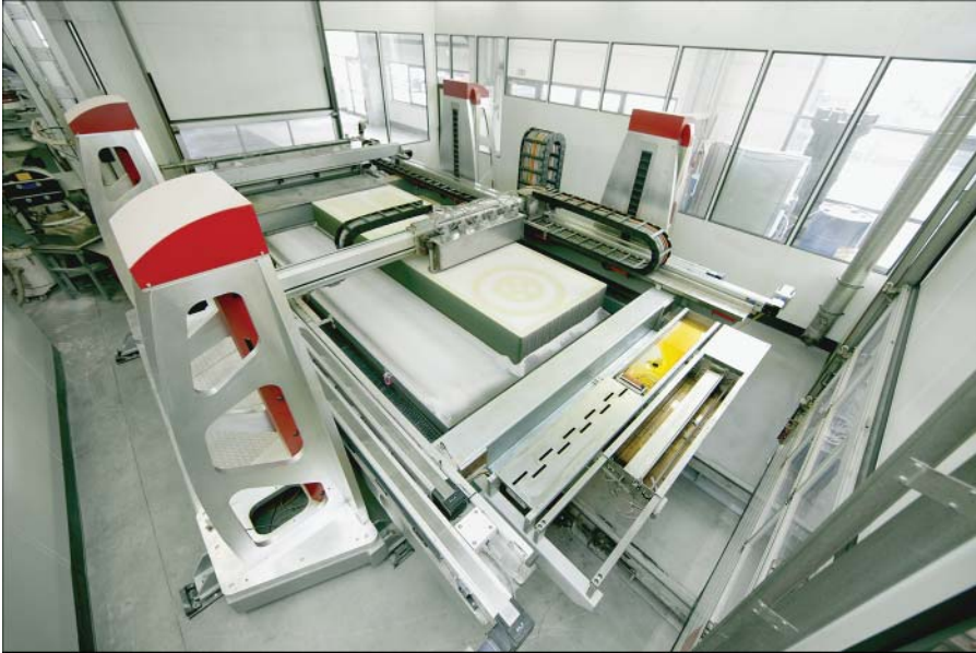
Abbildung 4.6: Der VoxelJet VX4000, der Granulatpulver unter Verwendung eines Systems zum Auftrag von Binder von oben bindet (Bild mit freundlicher Genehmigung von VoxelJet)
