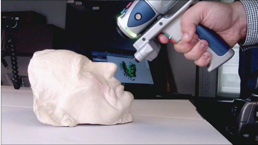
Abbildung 6.3: Mithilfe eines FARO-Lasers wird ein 3D-Modell dieser Maske erstellt. (Bild mit freundlicher Genehmigung des Smithsonian Institute)
