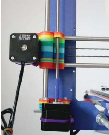
Abbildung 12.2: Der Antrieb der vertikalen Z-Achse eines Prusa i3-Druckers mit M5-Gewindestange und eingeworfener M5-Mutter
