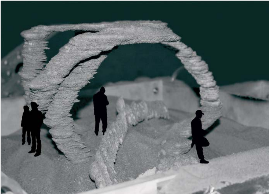
Abbildung 3.8: Eine Struktur, die entsteht, indem Sand mithilfe von Sonnenlicht geschmolzen wird (Bild mit freundlicher Genehmigung von Markus Kayser)
