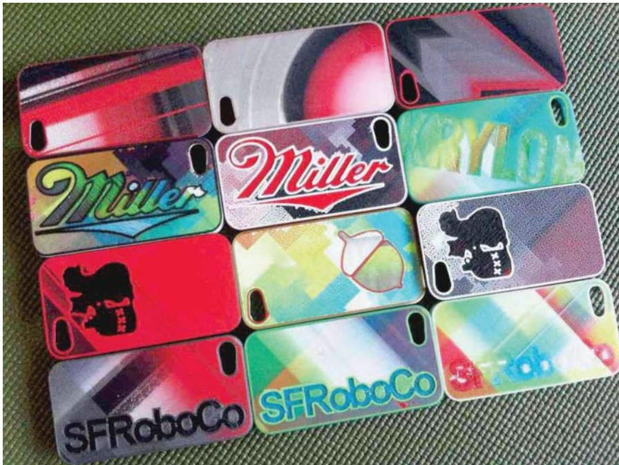
Abbildung 14.16: Diese iPhone-Gehäuse sind ein weiteres Beispiel für extremen Farbdruck für einzelne Schichten, wozu ein einziger Extruder verwendet wird. (Bild mit freundlicher Genehmigung von Matthew Bennett)
