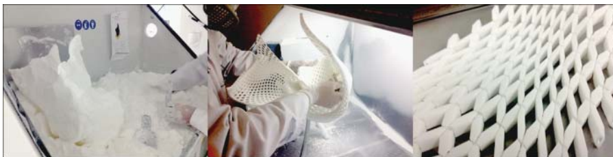
Abbildung 2.8: Ein bereits verbundenes Stück eines 3D-Druck-Kleidungsstücks wird aus einem Granular-Bindepulver-Bett genommen. (Bild mit freundlicher Genehmigung des Francis Bitoni Studios)
