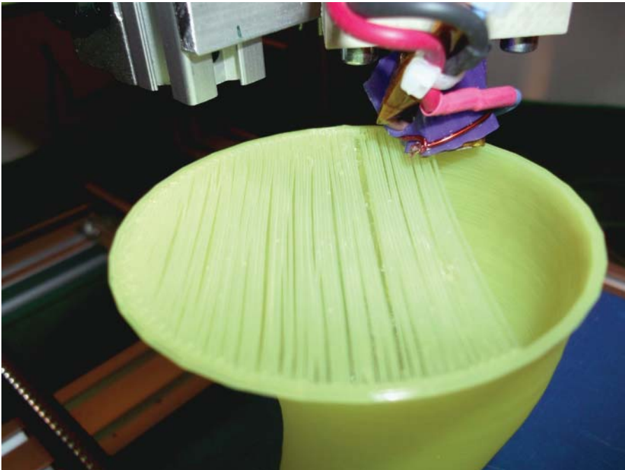
Abbildung 14.21: Hier müssen mit Fäden Brücken gespannt werden. Mit einer guten Kühlung und ein paar abwechselnd gedruckten Schichten wird dies zu einer soliden Oberfläche, auf die wieder gedruckt werden kann
