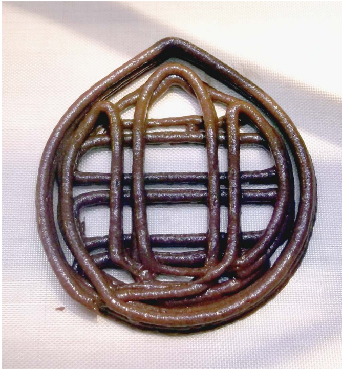
Abbildung 14.11: Für die Muffin-Mischung brauchen Sie nur eine einfache Spritze ohne Nadel, die einen 3 mm starken Extrusionswulst erzeugt.
