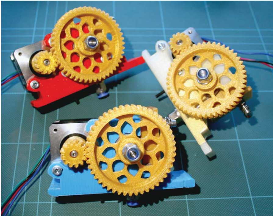
Abbildung 14.4: Die 3D-gedruckten Zahnrad-Extruder bestehen aus mehreren Teilen, können aber eine höhere Leistung und Geschwindigkeit für schnellere Drucke liefern.
