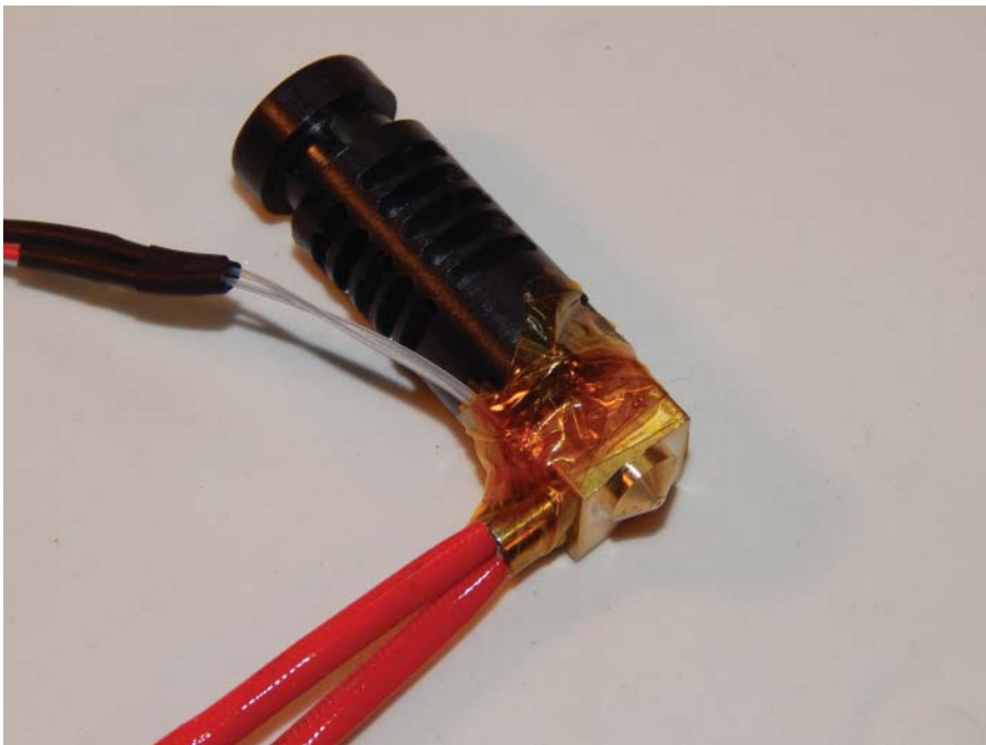
Abbildung 10.8: Ein standardmäßiger FFF/FDM-Extruder mit J-Kopf für das heiße Ende
