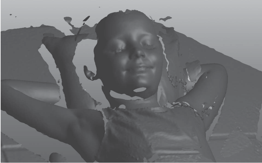
Abbildung 5.10: Software, die mehrere Scans des Motivs verknüpft. Haar wird nicht gut gescannt und muss deshalb vor dem Ausdruck bearbeitet werden.
