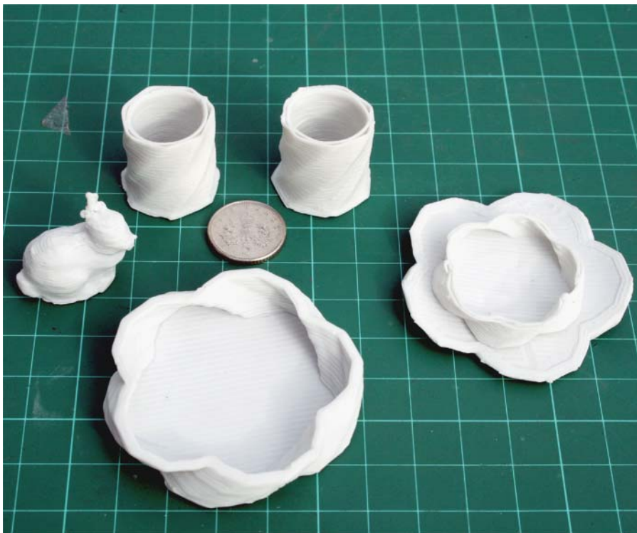
Abbildung 11.15: Feine Porzellanerde kann mithilfe eines Pasten-Extruders gedruckt und später sogar in normalen Brennöfen gebrannt werden, um Keramik herzustellen.
