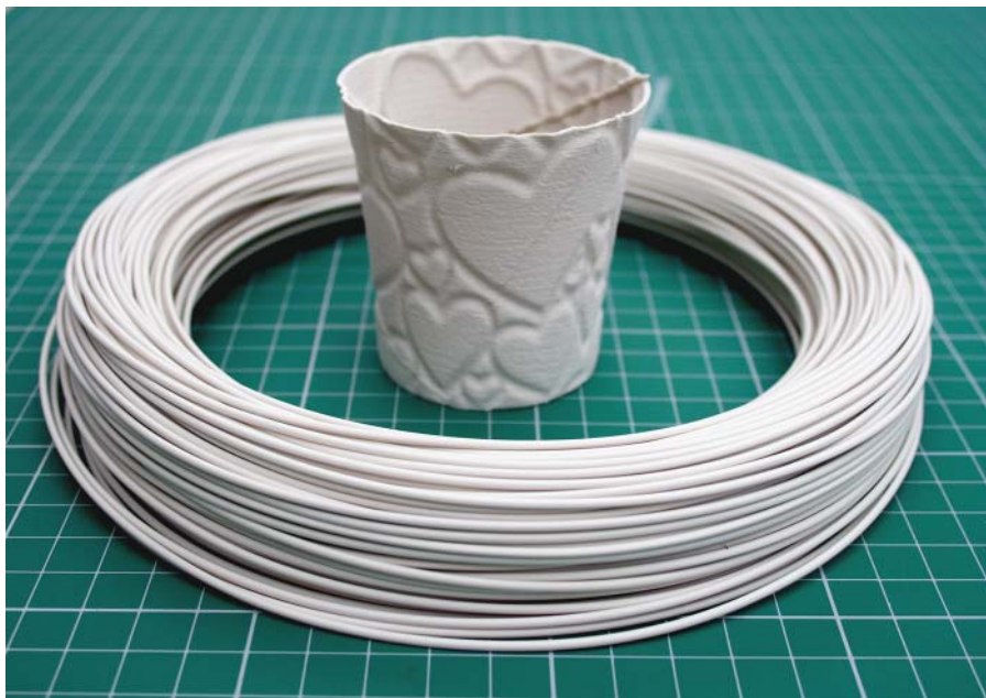
Abbildung 11.11: LayBrick ist relativ weich nach dem Ausdruck, ähnlich wie Kaugummi, härtet aber wie Kreide.
