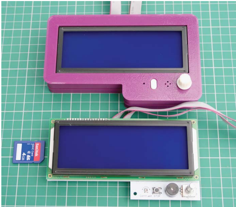
Abbildung 13.8: Die reine »Display«-Karte (unten) und dieselbe Karte in einem 3D-gedruckten Gehäuse (oben)
