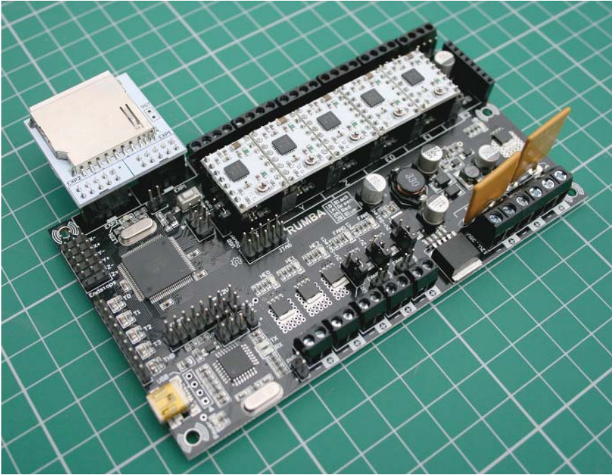
Abbildung 13.5: RUMBA mit einem Erweiterungsadapter für eine Speicherkarte, um den G-Code des Modells zu speichern – druckbereit
