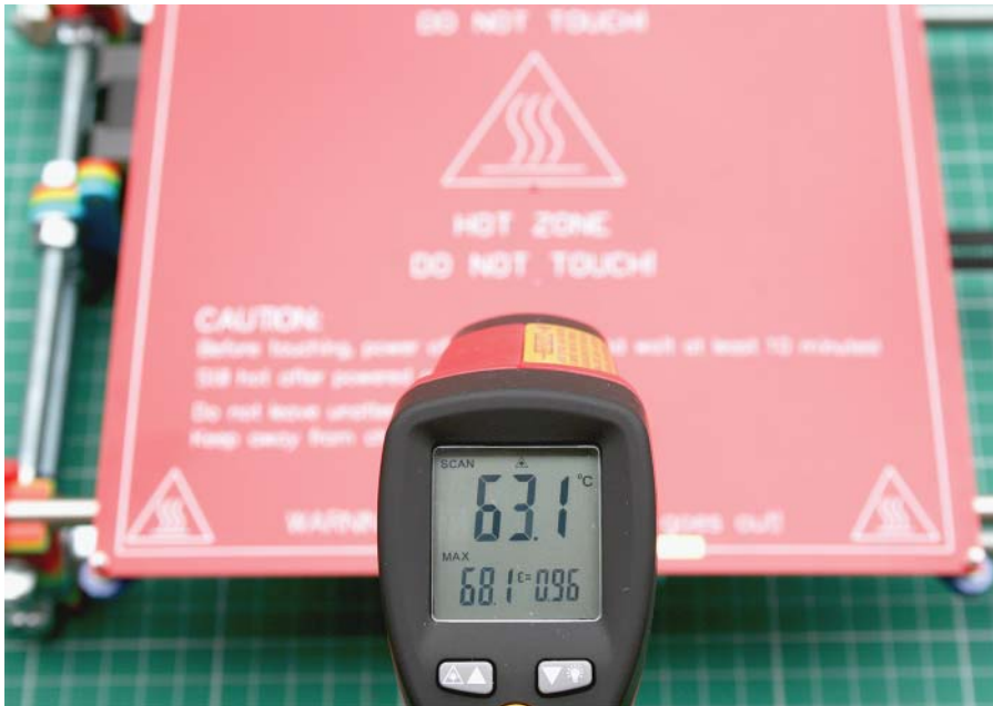
Abbildung 14.18: Ein kontaktfreier Lasertemperatursensor kontrolliert, dass Ihr 3D-Drucker mit der richtigen Temperatur betrieben wird.
