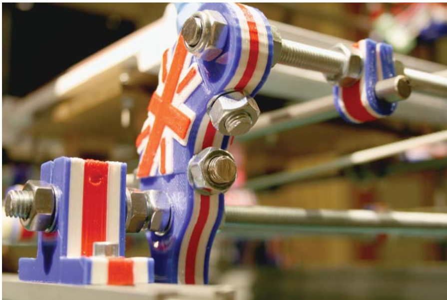
Abbildung 14.15: Mehrfarbiger Druck mit einem Extruder (selektiver Farbdruck für einzelne Schichten) unter Verwendung verschiedener Schichthöhen
