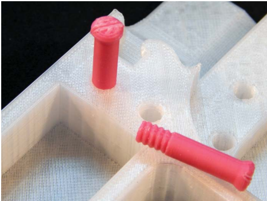
Abbildung 10.4: Komponenten dieser nicht funktionalen 3D-gedruckten Feuerwaffe werden mit 3D-gedruckten Schrauben zusammengehalten, die in am Modell dafür vorgesehenen Gewindelöchern angebracht werden.
