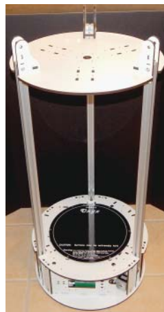
Abbildung 12.12: Bei der Montage werden Aluminiumschienen angebracht, um die vertikale Höhe des Delta-Druckers zu erzeugen.
