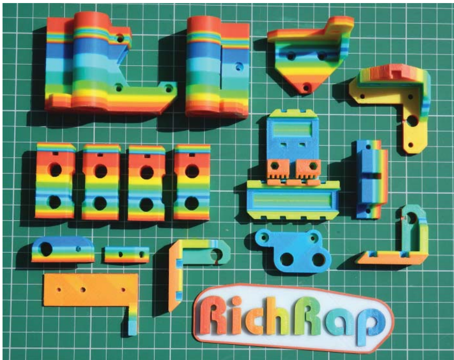
Abbildung 14.17: Mehrfarbendruck durch Abschneiden und Neuzuführen eines Fadens
