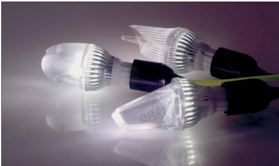
Abbildung 6.9: Die neuen Beleuchtungsdesigns von Disney verwenden 3D-gedruckte Hohllichtleiter. (Bild mit freundlicher Genehmigung von Karl Willis/Disney)
