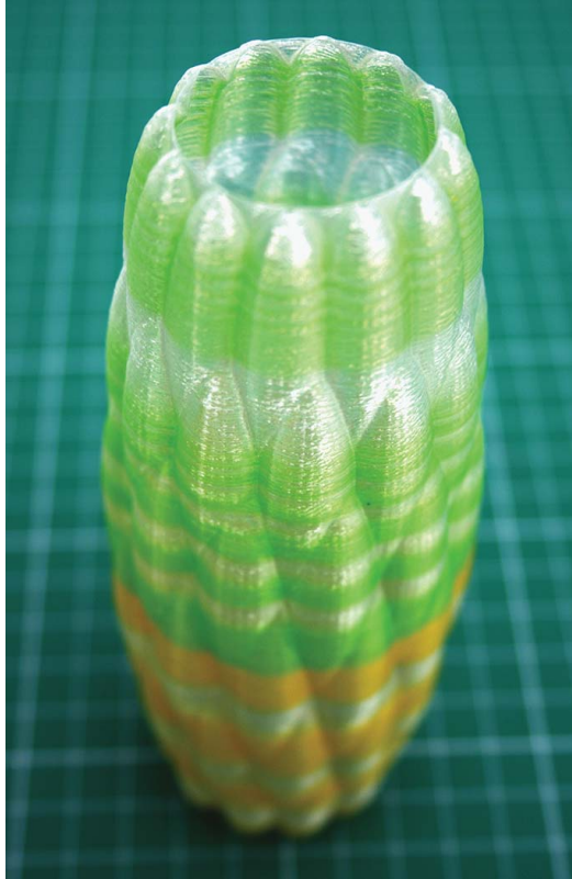
Abbildung 15.25: Das hohle 3D-Modell, ausgedruckt als Spiral Vase, wobei die vertikale Z-Achse kontinuierlich nach oben gefahren wird, sodass ein nahtloser Druck entsteht
