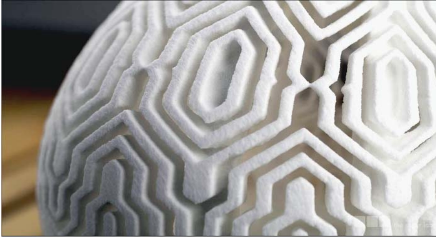
Abbildung 4.7: 3D-Druck unter Verwendung gebundener Zuckergranulate (Bild mit freundlicher Genehmigung von The Sugar Lab)
