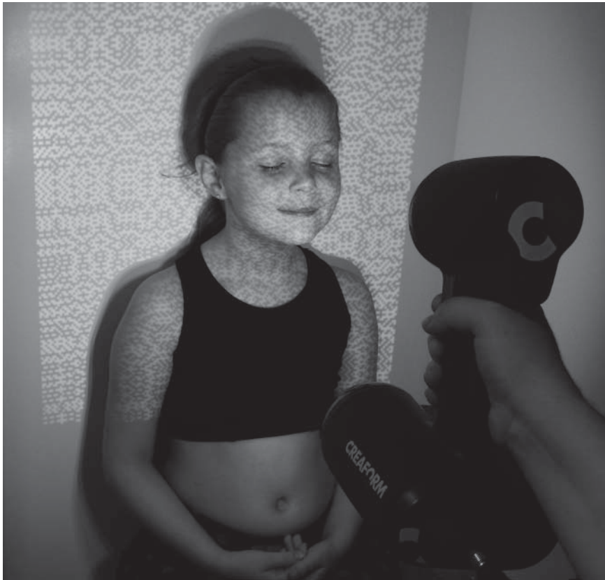
Abbildung 5.9: Der Handscanner Go!Scan von Creaform verwendet strukturiertes Licht, um ein menschliches Gesicht aufzunehmen.
