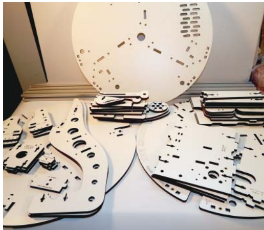
Abbildung 12.10: Ein hochpräzises Puzzle aus Holzteilen für den Rahmen des 3D-Druckers RostockMax
