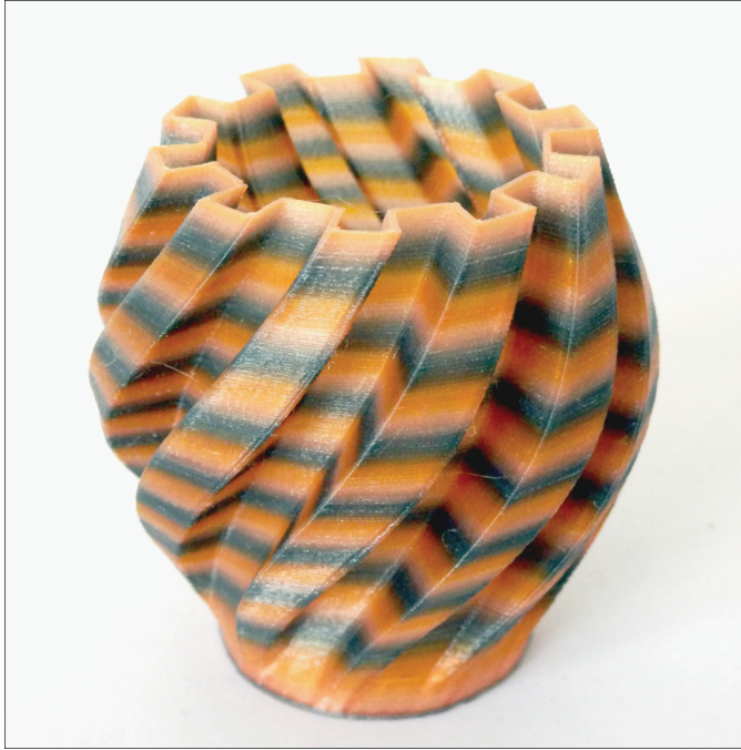
Abbildung 4.3: Ein gefärbtes Nylon-Objekt aus dem 3D-Drucker, wobei handelsübliche Textilfarben verwendet wurden
