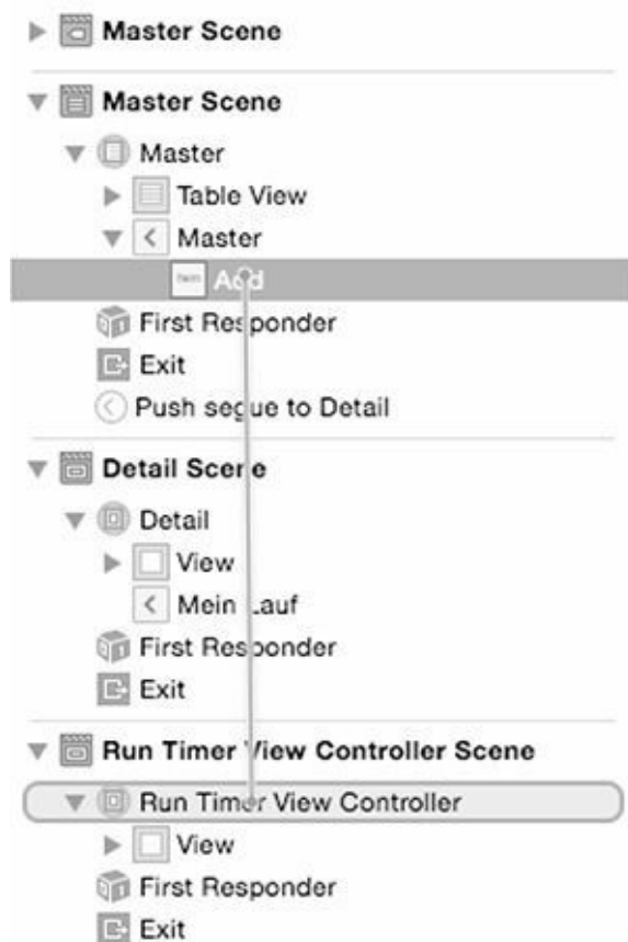
Abbildung 12-17: Erzeugen des Segues zwischen Master- und RunTimer View Controller
