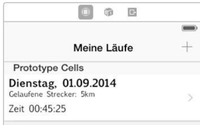
Abbildung 12-7: Fertiges Layout für die Table View-Zelle im Master View Controller
