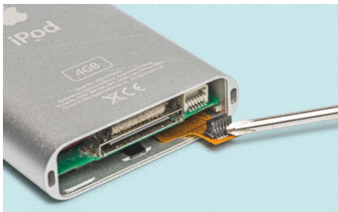
Das empfindliche Click-Wheel-Kabel muss gelöst werden, bevor sich das Innenleben nach oben herausdrücken lässt.
