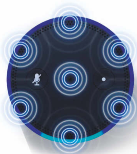
Gespitzte Ohren: Ein aus sieben Mikrofonen bestehendes Array sorgt dafür, dass Echo (Dot) auch leise Sprachbefehle erlauscht.
