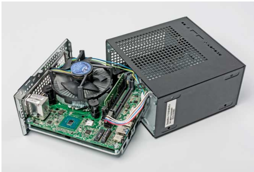
Der Mini-PC entsteht aus einem Barebone: CPU, Kühler und RAM sitzen oben auf dem Mainboard, die SSD kommt unter den Board-Träger.
