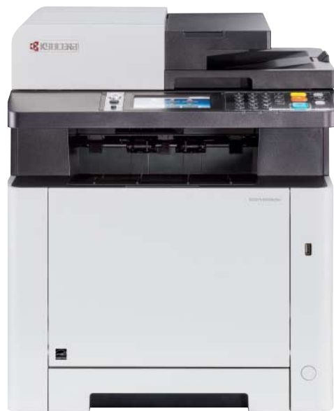
Der Multifunktions-Laserdrucker Kyocera Ecosys M5526cdw druckt, scannt und kopiert automatisch beidseitig.
