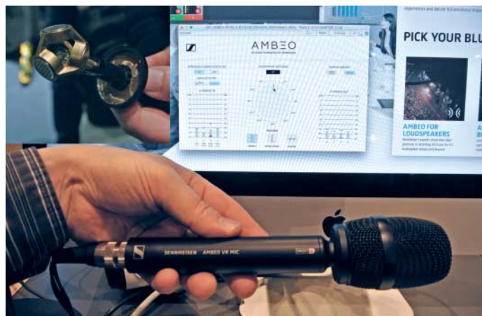
Das Ambeo VR Mic von Sennheiser nimmt 4-kanaligen Surround-Sound mittels First Order Ambisonics beispielsweise für 360-Grad-Videos auf.
