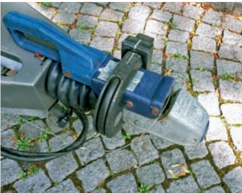
◀ Sicherung der Kupplung gegen Öffnen und Abschrauben
