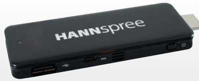
Rechts der Ein-/Ausschalter, in der Mitte die Micro-USB-Buchse für die Stromversorgung, links die einzige USB-Buchse zum Anschließen der Peripherie. Der Slot für Micro-SD-Karten befindet sich auf der Rückseite.
