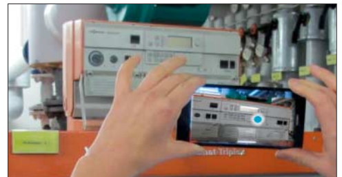
Der Kunde filmt ein defektes Gerät, tele-Look überträgt das Bild zum Handwerker und der signalisiert mit dem blauen Punkt, was er genauer sehen möchte.
