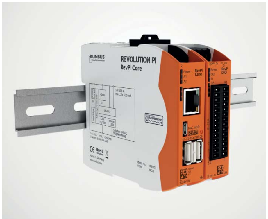
Kunbus' RevolutionPi Core lässt sich auf eine Hutschiene montieren, hier zusammen mit DIO-Modul (rechts).
