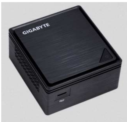
Gigabyte Brix BPCE-3350: Mini-PC mit HDMI 2.0 und HEVC-fähigem Intel-Prozessor Celeron N3350
