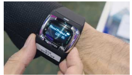
Referenzdesign: Mediatek-Uhr mit EKG und Blutdruckmessung
