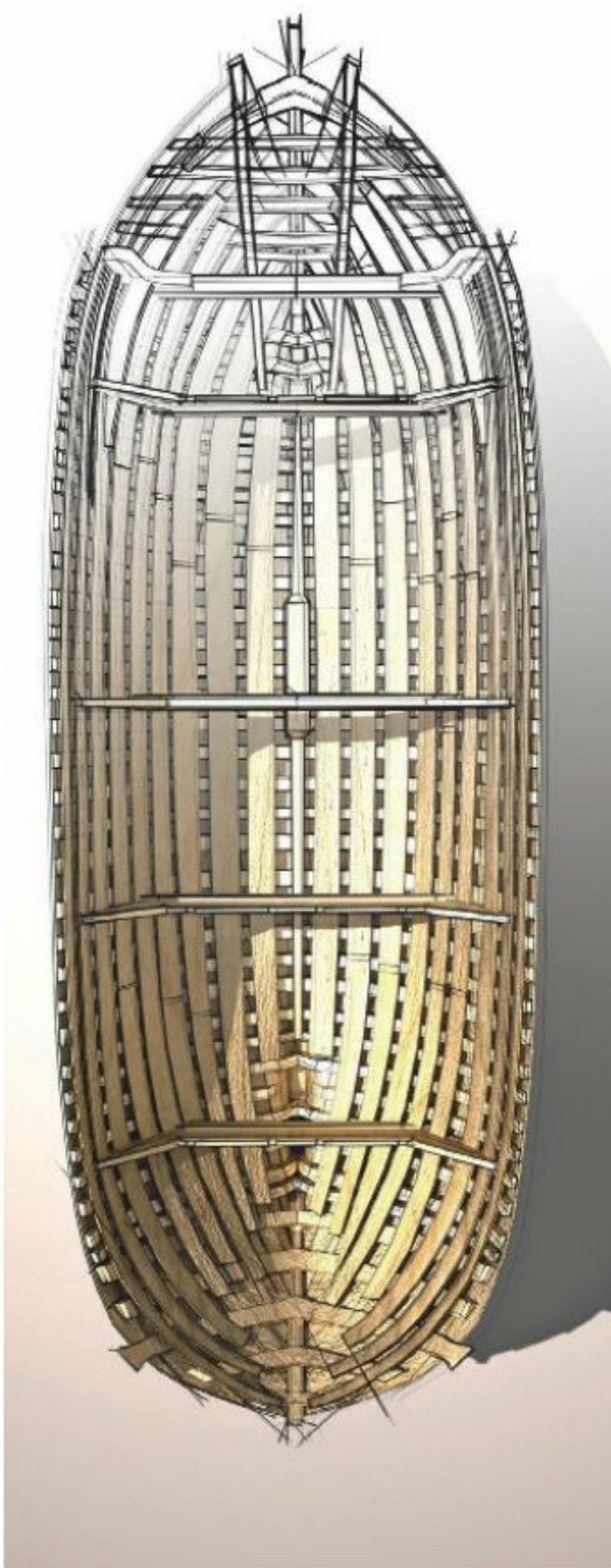
Der mächtige Rumpf der Kogge ist ihr größter Vorteil – er ist geräumiger als bei anderen Schiffstypen. Rund 23 Meter ist der Segler lang und etwa sieben Meter breit. Die Planken müssen tonnenschweren Lasten standhalten, daher stabilisieren Querstreben die Außenwände
