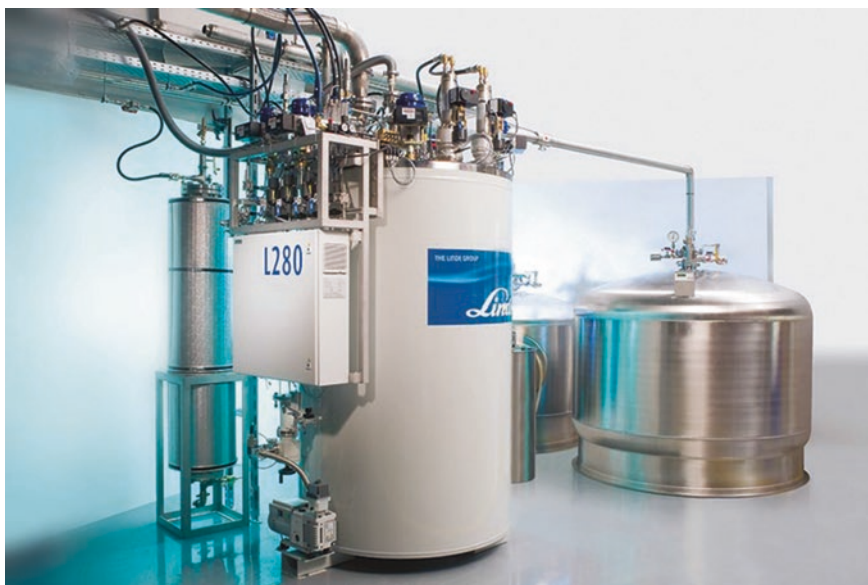
Abb. 1.3 Moderne Anlage zur Verflüssigung des Edelgases Helium. Links sind die Steuerung und die Coldbox des Verflüssigers abgebildet, rechts der Vorratsbehälter für flüssiges Helium. (Foto: © Linde AG)
