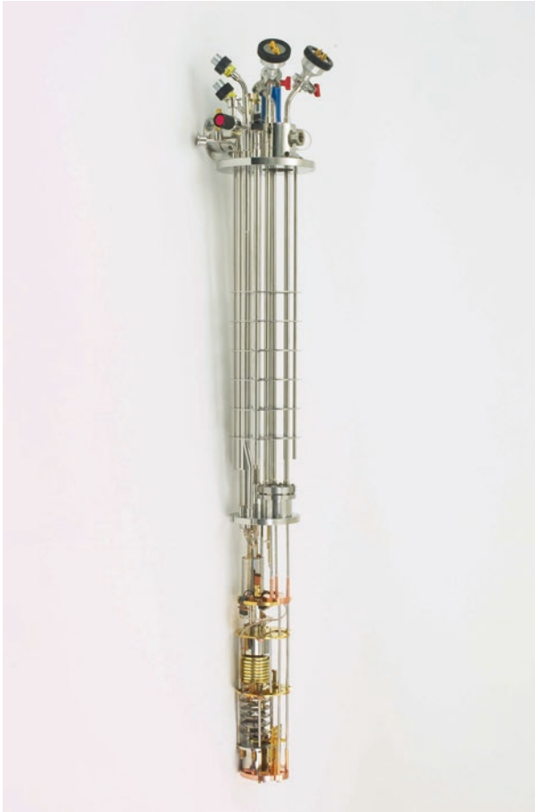
Abb. 1.4 Mischkryostat zur Abkühlung auf Temperaturen deutlich unterhalb 1 K. Unten befindet sich das kälteste Ende mit der Mischkammer. Oben erkennt man den Flansch zum Einbau in den evakuierbaren Kryobehälter. (© Fa. Oxford. Mit freundlicher Genehmigung)
