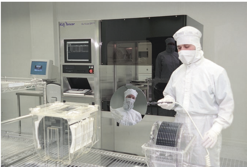
Abb. 6.11 Verarbeitung der Silizium-Wafer mit 30 cm Durchmesser. (Foto: © Wacker-Chemie AG)
