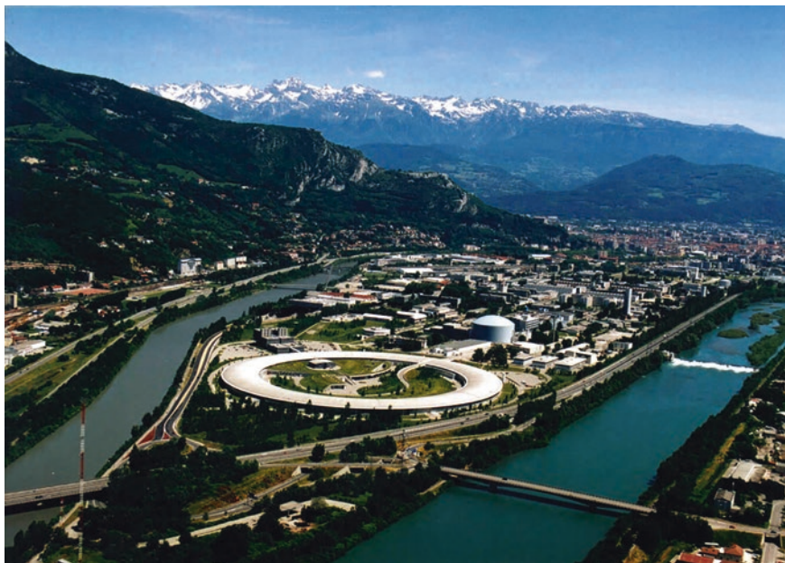
Abb. 2.10 Luftaufnahme der großen europäischen Synchrotron-Strahlenquelle in Grenoble (heller Ring im Vordergrund). Der runde turmartige Behälter neben dem Ring ist die Außenhülle des deutsch-französischen Forschungsreaktors des Laue-Langevin-Instituts. (© Studio de la Révirée, Grenoble)
