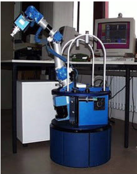
Bild 7-8: Autonomer mobiler Roboter Blue Kiss (Hochschule Bochum)
