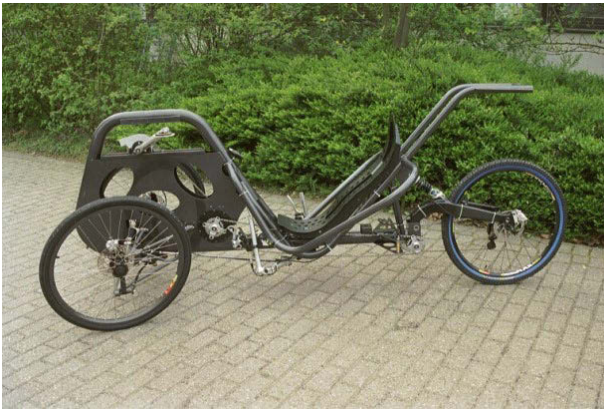
Bild 9-72: Rahmenaufbau des VIRAGETTE-Neigefahrrads
