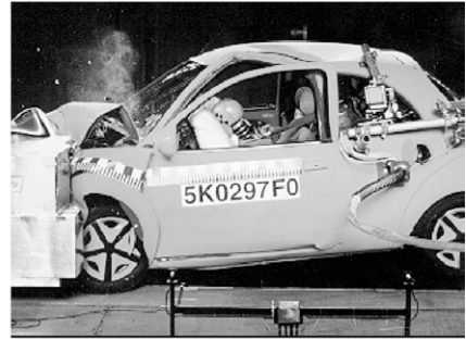
Bild 1-25: Auslösen eines Airbags in einem PKW
