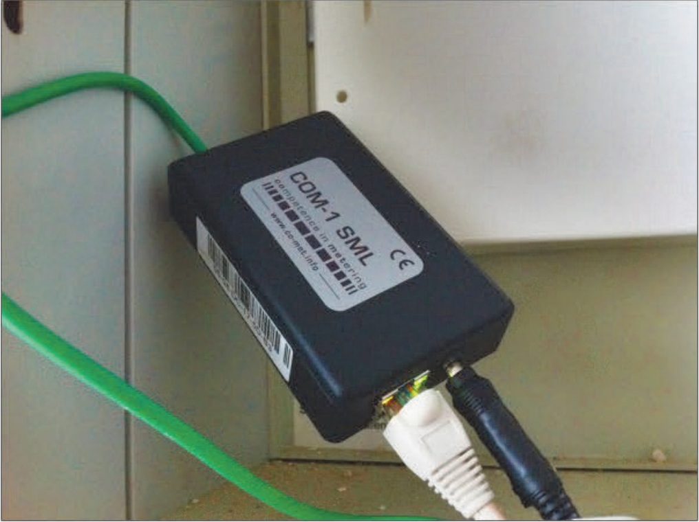
Abbildung 36.1 Das schwarze Kästchen stellt die Zählerdaten per HTTP zur Verfügung.
