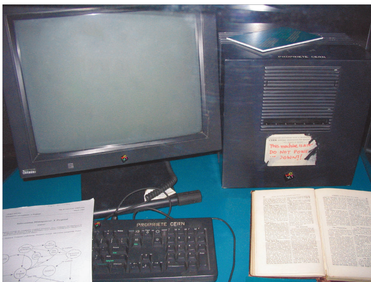
Abbildung 12.1 Die Hardware des ersten Webservers von Tim Berners-Lee am CERN (Quelle: » https://commons.wikimedia.org/wiki/File:First_Web_Server.jpg «, CC BY-SA 3.0, attributed to Coolcaesar at the English language Wikipedia)
